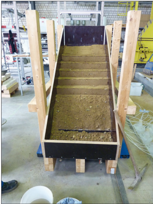
Bild 6: Abtragen des treppenförmigen eingebauten Bodenmaterials zur Herstellung der Böschungsneigung
