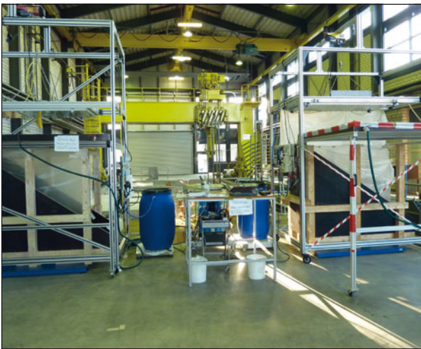
Bild 10: Gesamtansicht der zwei Lysimeter mit Wasservorratsbehältern und Arbeitsplatz
