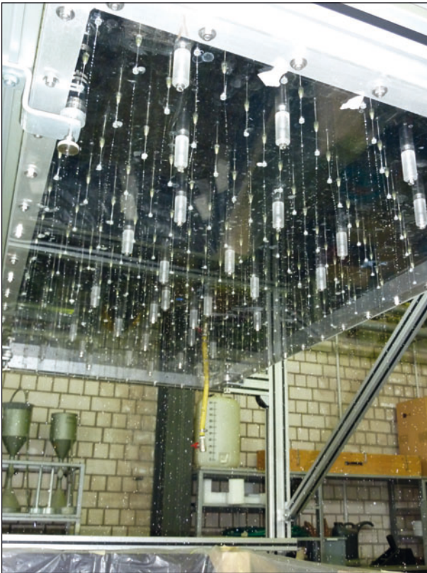
Bild 9: Detailaufnahme des Beregnungskopfes von untern während der Beregnung
