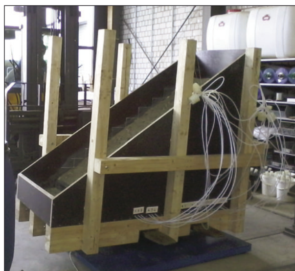
Bild 3: Seitenansicht des Lysimeterkastens, beim Aufstellen auf die Waage
