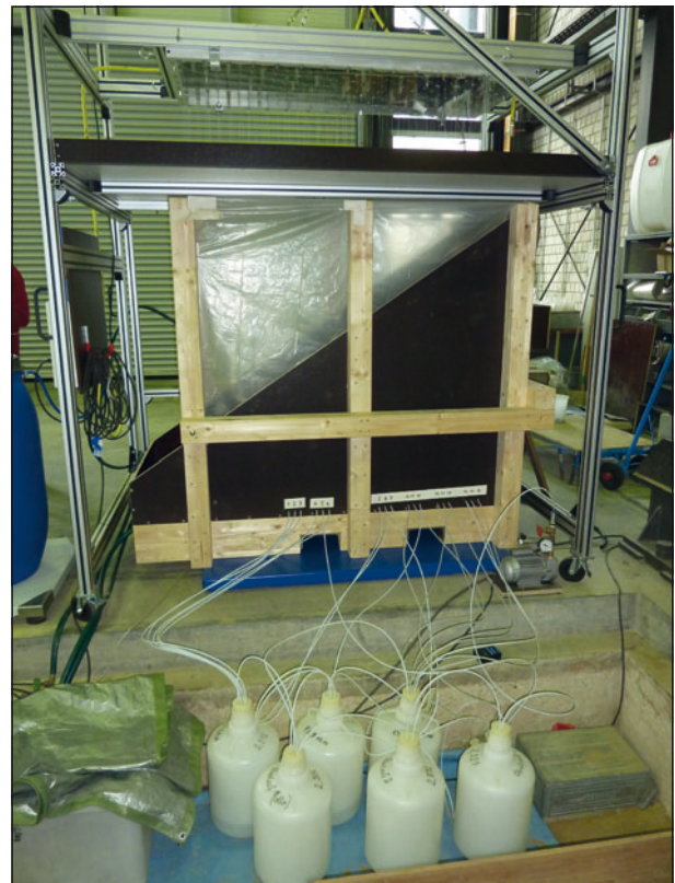
Bild 12: Beregnungskopf über Lysimeterkästen mit Sammelflaschen (Seitenansicht)
