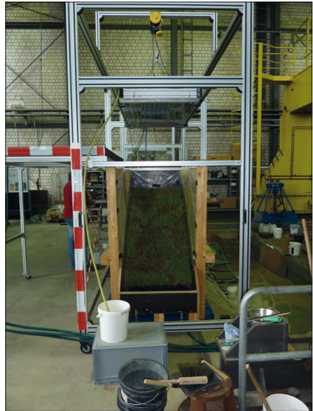
Bild 11: Beregnungskopf mit Gestell und offener Schublade über Lysimeterkästen (Vorderansicht)
