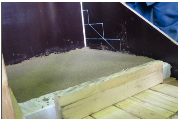
Bild 7: Detailansicht des treppenförmigen Einbaus des Bodenmaterials in den Lysimeterkasten
