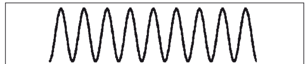
Bild 37: Prinzip Versuchstyp 1: Beanspruchung ohne Lastpause („klassischer“ Ermüdungsversuch)
