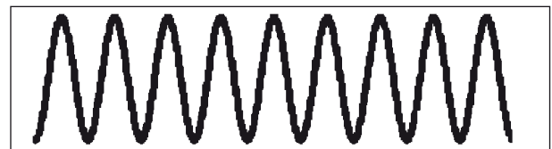
Bild 21: Prinzip Versuchstyp 1: Beanspruchung ohne Lastpause (klassischer Ermüdungsversuch)
