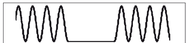
Bild 39: Prinzip Versuchstyp 3: Längere Lastpause zwischen zwei Belastungsphasen
