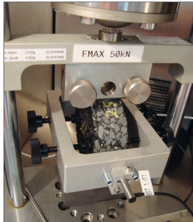
Bild 6: Prüfvorrichtung mit eingebautem Probekörper für den Spaltzug-Schwellversuch
