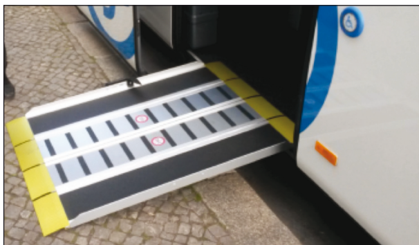
Bild 10: Kontrastreiche Markierung einer mobilen Rampe. Hier fehlt jedoch die nach R-107 Abschnitt 3.11.4.1.6 vorgeschriebene Markierung in Längsrichtung der Rampe (Foto: HFC)
