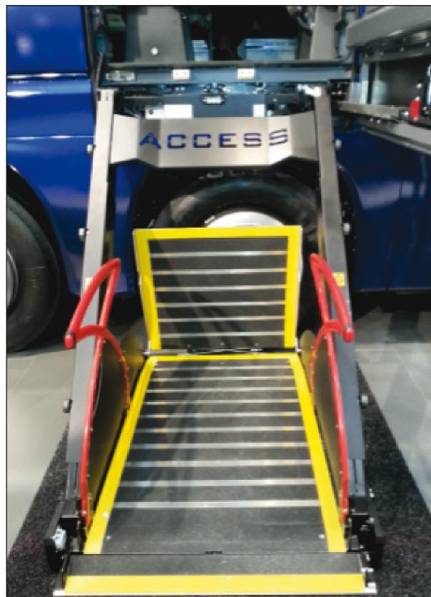
Bild 11: Kontrastreiche Markierung eines Hublifts
