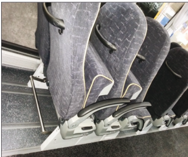
Bild 5: Zusammengepresste Sitzreihen im Modell EX 16 M von van HOOL. Erkennbar sind auch die kontrastreich markierten Seitenränder der Sitze (Foto: HFC)
