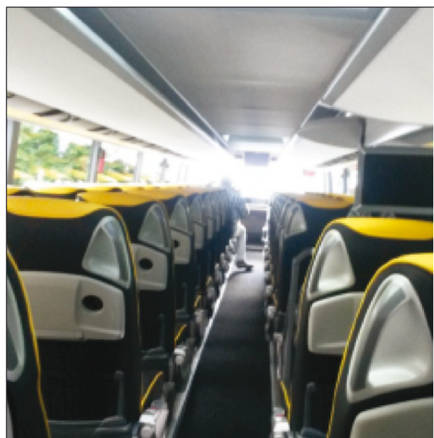
Bild 9: Kontrastreiche Markierung der Sitze, jedoch nicht der Griffe und Griffmulden (Foto: HFC)
