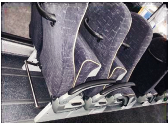
Bild 2: Beispiel Schiebesitzlösung: van HOOL, IAA Nutzfahrzeuge (Foto: HFC)
