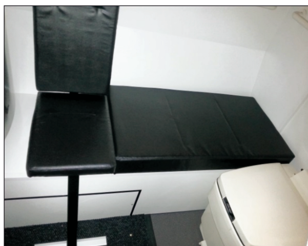
Bild 3: Bustoilette im Modell „Futura“ von VDL Bus & Coach. Im Bild links erkennbar ist der mit dem Schienensystem verbundene Sitz (Foto: HFC)
