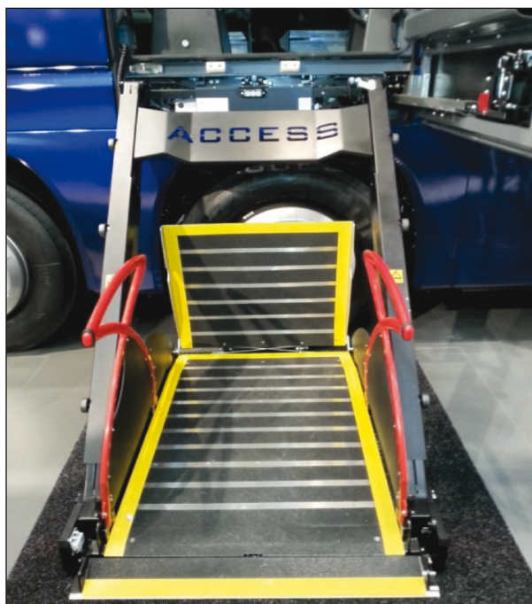
Bild 4: Einstiegshilfe im Modell „Futura“ von VDL Bus & Coach (Foto: HFC)
