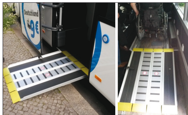
Bild 7: Mobile Rampen für Doppeldeckerfahrzeuge (Foto: HFC)
