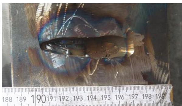
**Bild A 31:** Umbau Versuchskörper 09 – Gurtansicht nach stegseitigem Zuschweißen des ausgearbeiteten Bereichs
