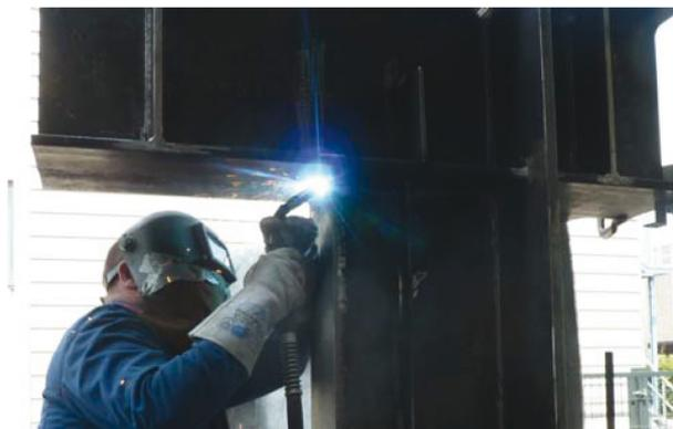
**Bild A 40:** Umbau Versuchskörper 18 – Schweißen der Gurtnaht (Schweißposition PD)
