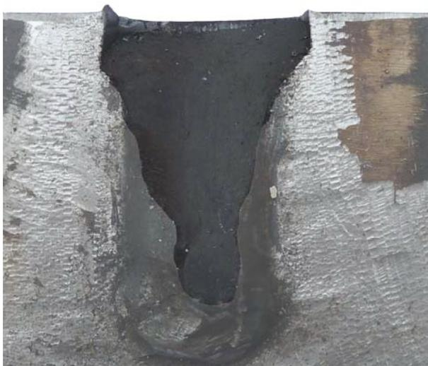
Bild A 42: Rissoberfläche Steg in der Druckzone
