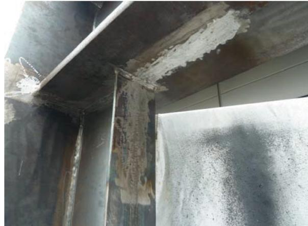
Bild A 26: Umbau Versuchskörper 04 – Anschlussbereich des alten Knotenblechs nach dem Entfernen des restlichen Überstands mit einem Winkelschleifer
