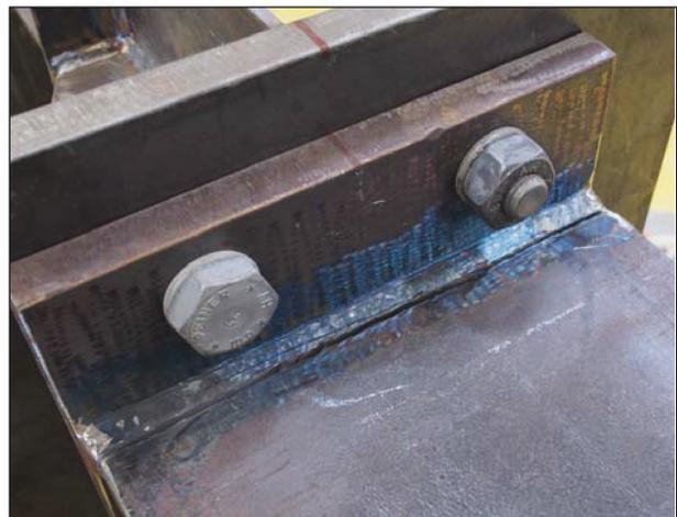
Bild 121: Durchgerissener Zuggurt des Lasteinleitungsträgers
