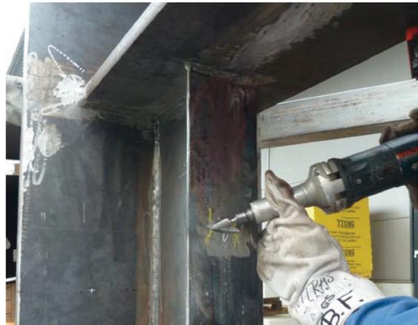
Bild A 27: Umbau Versuchskörper 05 – Schrittweise Ausschleifen des Risses mit einem Fingerschleifer im Wechsel mit MT-Prüfungen
