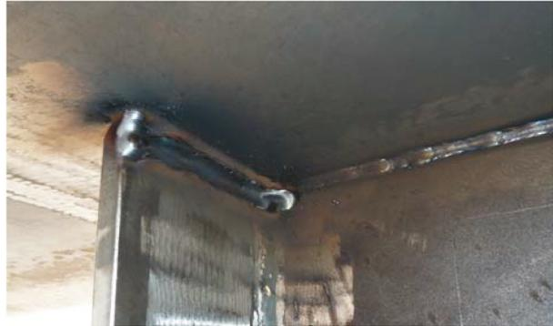
**Bild A 38:** Umbau Versuchskörper 16 – Schweißen der Wurzellage für Gurt- und Steгнаht
