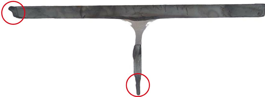
Bild A 44: Rissoberfläche des Obergurts und Stegs in der Zugzone
