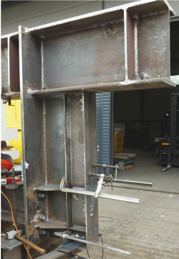
**Bild A 36:** Umbau Versuchskörper 14 – Vormontage und Ausrichtung des verstärkenden Bauteils; um den Spalt zwischen altem und neuem Bauteil auf ein verträgliches Maß (~2mm) zu reduzieren, waren Richtarbeiten erforderlich
