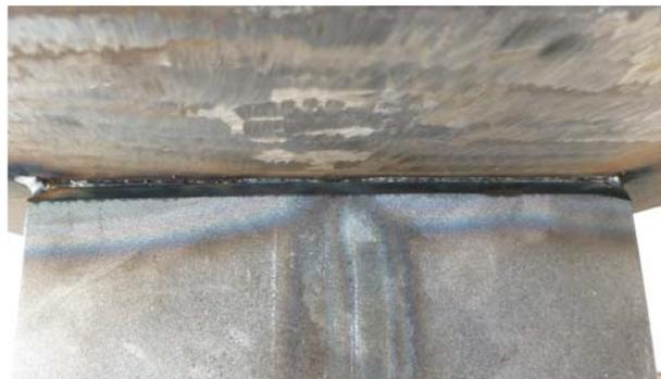
**Bild A 39:** Umbau Versuchskörper 17 – Gurtseitige Ansicht der Wurzel vor dem Ausschleifen
