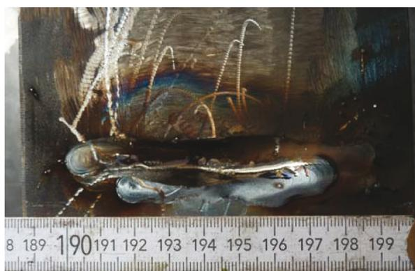
**Bild A 33:** Umbau Versuchskörper 11 – Lagenweise Auffüllen des ausgearbeiteten Bereichs; nach jeder Raupe wurden die Verunreinigungen ausgeschliffen
