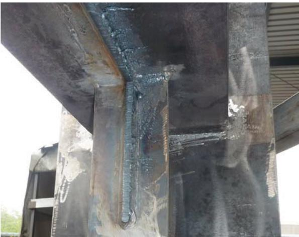
Bild A 24: Umbau Versuchskörper 02 – Brennkante nach dem Herauslösen des alten Knotenblechs, verbliebener Überstand ca. 10 mm
