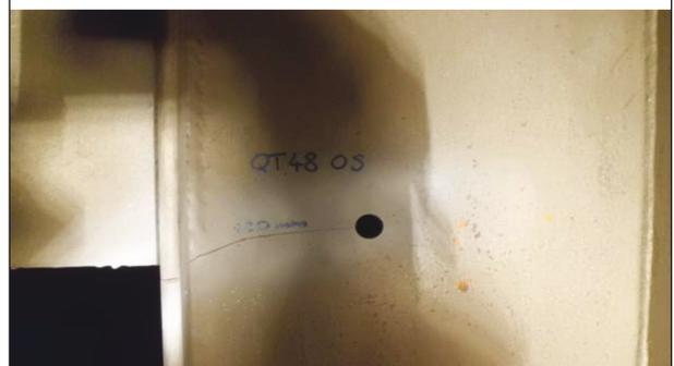
**Bild 45:** Risse ausgehend von der Umschweißung der Knotenbleche, [U56]
