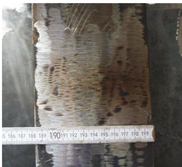
**Bild A 34** Umbau Versuchskörper 12 – Gurtansicht nach Abschluss der Reparaturschweißungen
