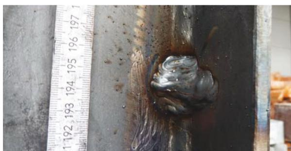
**Bild A 30:** Umbau Versuchskörper 08 – Stegseitiges Zuschweißen des ausgearbeiteten Bereichs (Verfahren 135 MAG, Gas M21)
