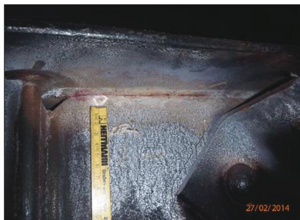
**Bild 55:** Riss in der Schweißnaht zwischen Knotenblech und Querträger-Untergurt, aus [U59]
