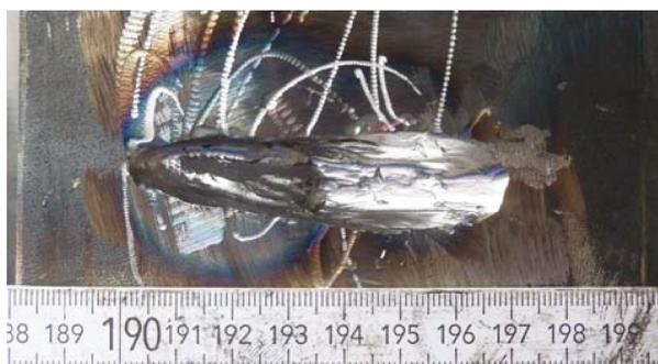
**Bild A 32:** Umbau Versuchskörper 10 – Gurtansicht nach Ausschleifen der Verunreinigungen
