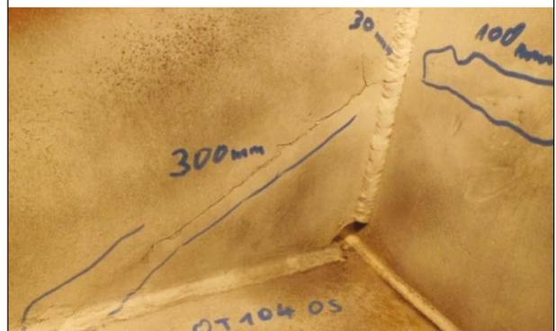
**Bild 44:** Risse im Bereich der Lasteinleitungssteife [U56]
