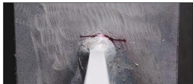
**Bild 116:** Schweißnahttriss an der oberen Umschweißung des Knotenblechs vorne; Länge 25 mm
