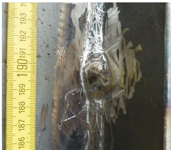
**Bild A 35:** Umbau Versuchskörper 13 – Stegseitige Ansicht nach Abschluss der Reparaturschweißung (vgl. Bild A 30)
