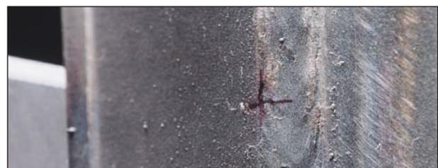
**Bild 117:** Schweißnahttriss einseitig bis in Halskehlnaht auf der Gegenseite gewachsen
