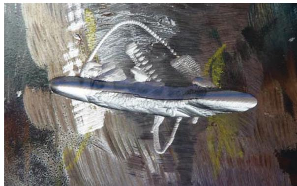
Bild A 28: Umbau Versuchskörper 06 – MT-Anzeige des teilweise ausgeschliffenen Risses; durch das sukzessive Vorgehen kann der Rissverlauf über die Blechdicke dokumentiert werden
