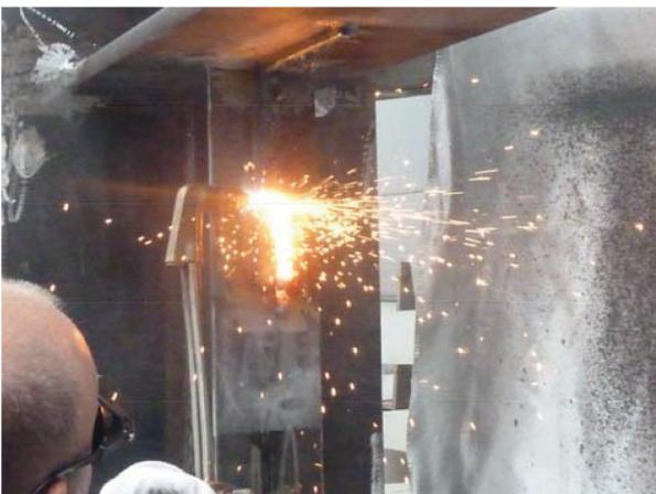
Bild A 25: Umbau Versuchskörper 03 – Reduzierung des verbliebenen Überstands mit „weicher Flamme“ auf ca. 3 mm
