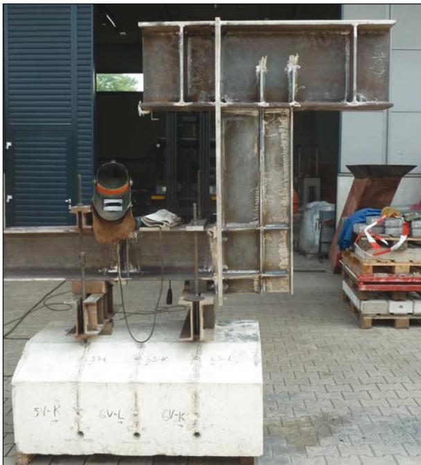
Bild 119: Versuchskörper nach Abschluss der Reparatur- und Umbauarbeiten
