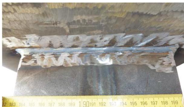
**Bild A 41:** Umbau Versuchskörper 19 – Ansicht der vollständig geschweißten Gurtnaht
