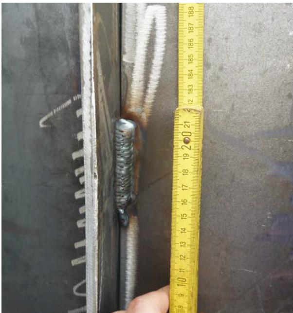
**Bild A 37:** Umbau Versuchskörper 15 – Heftschweißung auf halber Höhe des Stegs (Verfahren 135 MAG, Schutzgas M21, Position PF Steгнаht)
