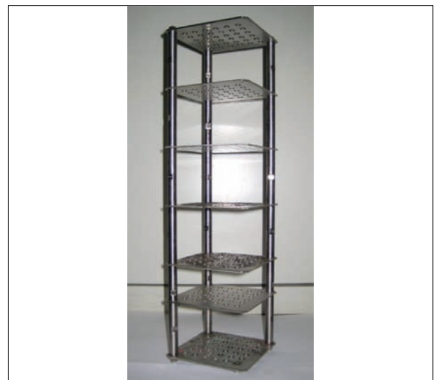
Bild 2: Siebträgergestell für die SATS-Prüfung
