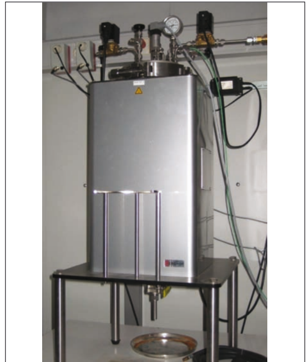
Bild 1: Druckalterungsbehälter für die SATS-Prüfung
