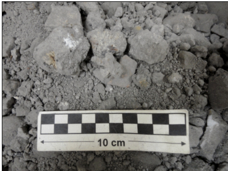
Baustoffgemisch AP2-10: HMVA
