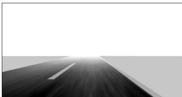
Bild 3: Darstellung der Nebelsimulation mit 30 m Sichtweite in der Vorstudie 2; Original in Farbe
