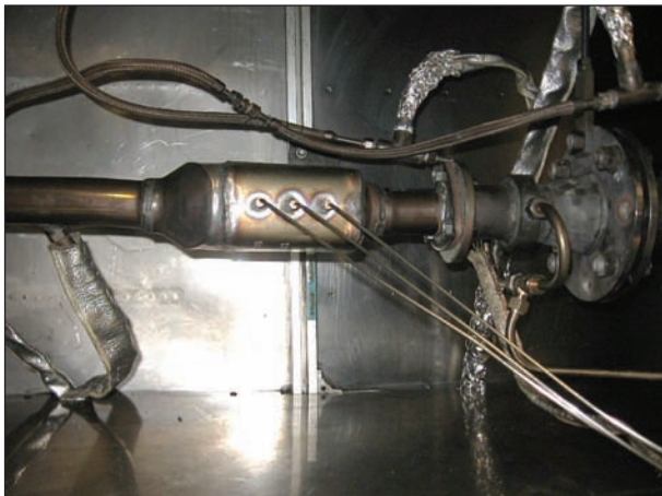
Bild 3.7: Prüfling mit Temperatur-Messstellen auf dem Brennerprüfstand
