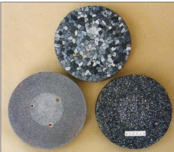
Bild 5: Standardprüfkörper nach TP Gestein [4] (oben: Mosaik 8/11; unten links: Sandplatte; unten rechts: Mastix 2/5)
