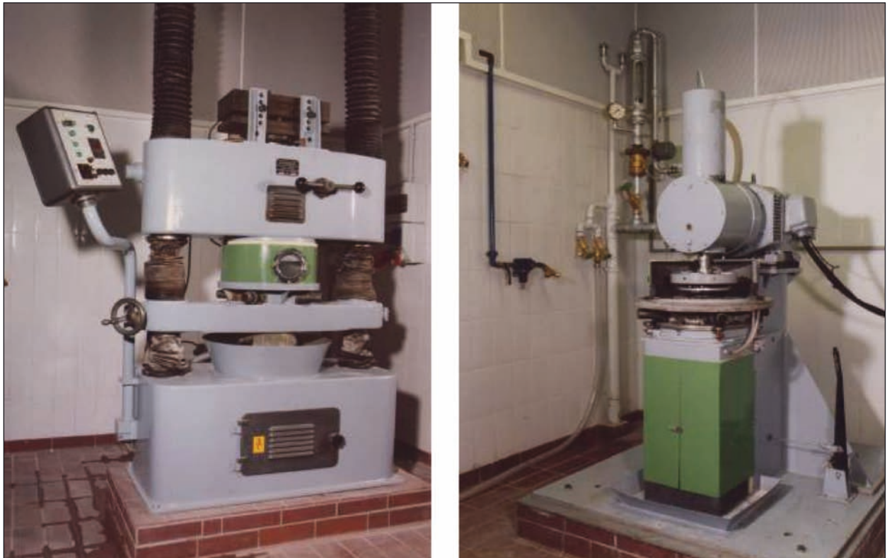
Bild 3: Prüfanlage nach WEHNER/SCHULZE – 1. Prüfanlage der TU Berlin (links: Poliereinrichtung; rechts: Laborgriffigkeitsmessgerät)
