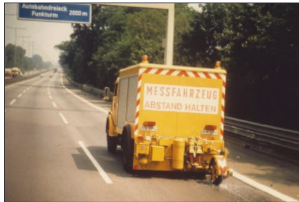
Bild 2: Stuttgarter Reibungsmesser (SRM)
