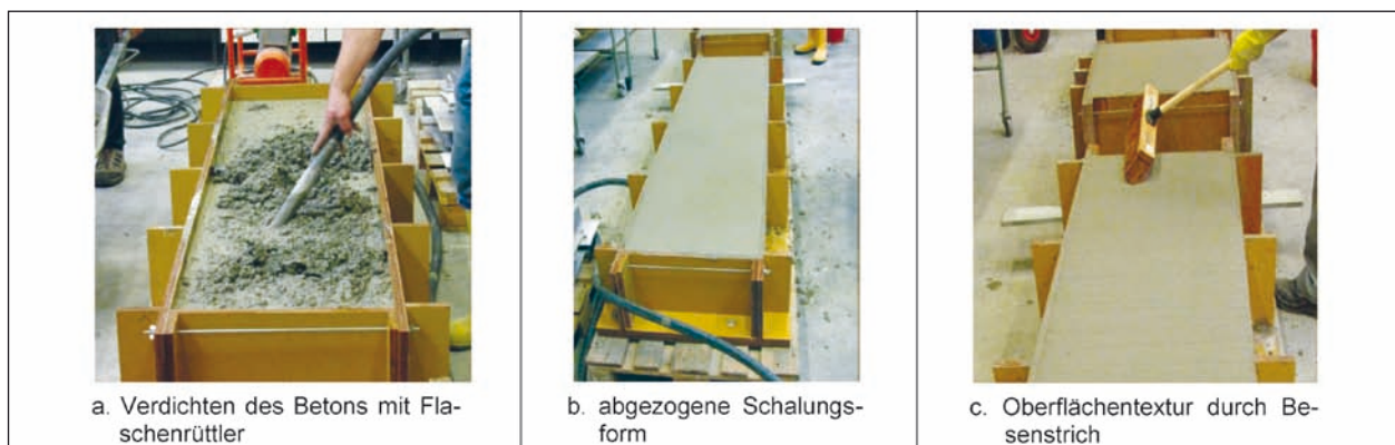
Bild 33: Dokumentation der Balkenherstellung aus Laborbeton
