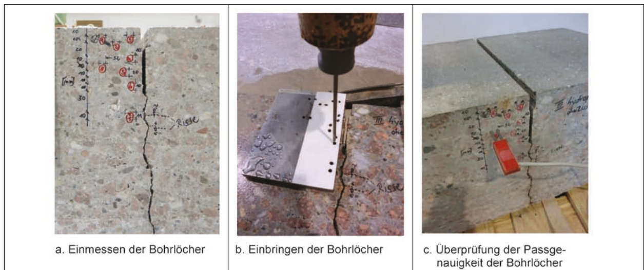
Bild 83: Vorbereitung der Auslagerungssegmente für das Einbringen der Messsonden
