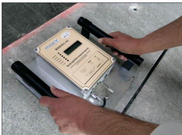
Bild 6: Hydrophobiermessgerät HDBMG-02 zur Beurteilung der Wirksamkeit/Qualität von Hydrophobierungen entsprechend ZVT-Ing, Teil 3, Abschnitt 4 [7]
