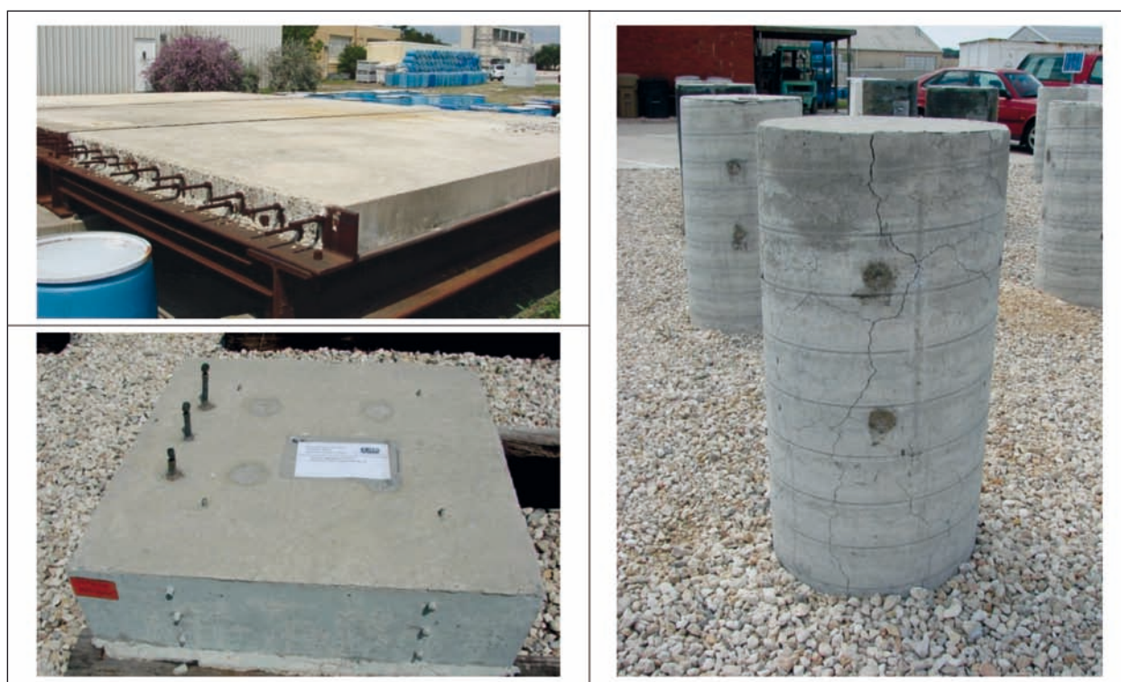
Bild 14: Versuchsfeld in Austin (Texas) zur Überprüfung der Wirksamkeit von Hydrophobierungen an unbewehrten Betonplatten (unten links), bewehrten Brückenfahrbahnen (oben links) und Stützen (rechts)
