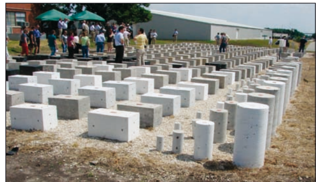
Bild 13: Auslagerungsstandort in Austin Texas von Betonblöcken 710 mm x 380 mm x 380 mm mit verschiedenen Betonzusammensetzungen und Oberflächenschutzbehandlungen
