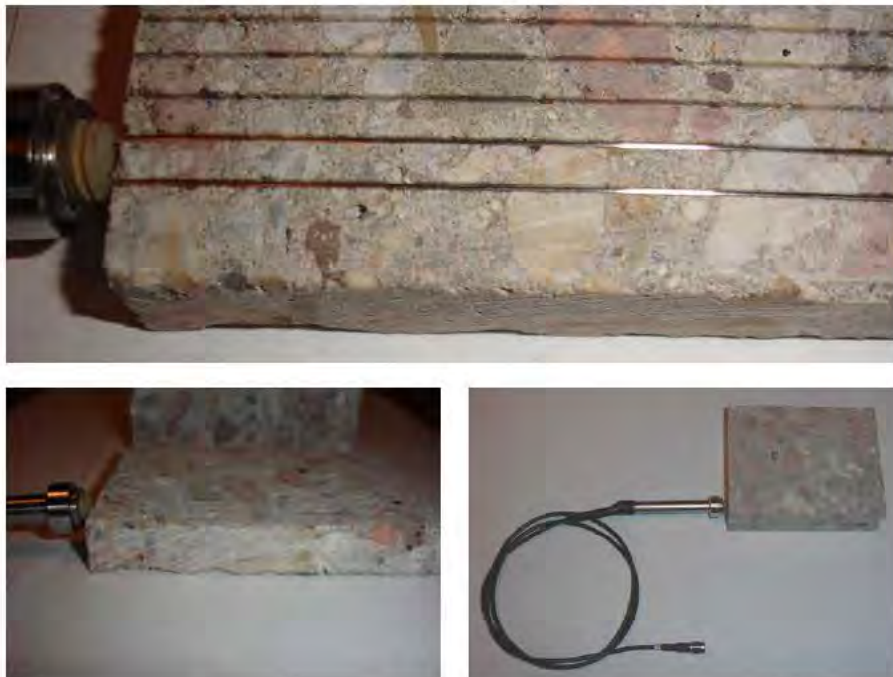
Abbildung 8: Im unteren Doppelschlitz des Betons ist die TDR-Sonde installiert. Danach wird der plane Deckel auf den geschlitzten Beton gelegt und die Messung ausgelöst.
