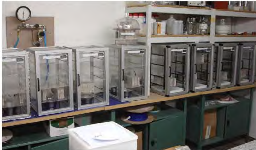
Abbildung 7. Konditionierung der Straßenbetonproben über gesättigten Salz-in-Wasser Lösungen in Exsikkatoren. Um den Feuchteausgleich zwischen Betonprobe und Lösung zu fördern, wälzt ein Ventilator die Luft im Exsikkator kontinuierlich um. Zum Erhalt relativ trockener Feuchtebedingungen sind z.B. bei 11.3%rH alle Tür-Fugen eines Exsikkators mit einer luftdichten Alufolie verklebt.
