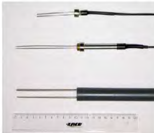
Abbildung 3. TDR-2-Stabsonden in verschiedenen Dimensionen. (Der Sondentyp in Bildmitte mit 53mm kurzen Sondenstäben wurde bei den Kalibriermessungen verwendet.)
