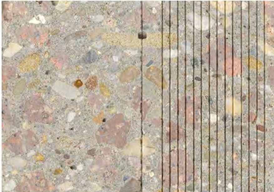
Abbildung 6. Foto vom Anschnitt der beiden korrespondierenden Probenhälften (Probe F3 und Probe F4). Die Probe F4 (rechts) ist mit 7 Doppelschlitz für die Aufnahme der TDR-Sonden versehen.
