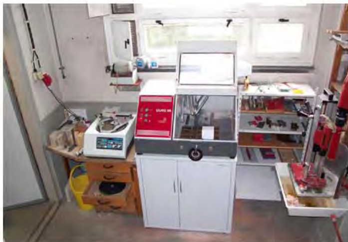
Abbildung 5. Nass- Trenn- Schleif- Schneid- Arbeitsplatz für Präzisionsarbeiten mit Läppmaschine (links) und Schneidmaschine (Mitte) zur Bearbeitung der Betonproben.
