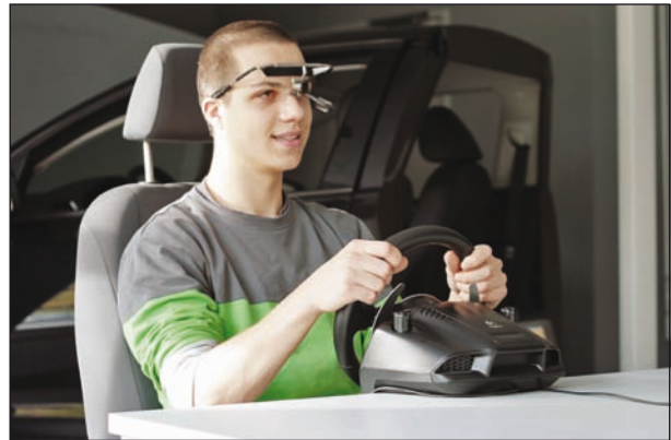
Bild 6.5: Proband mit Blickfassungssystem Dikablis (Ergoneers GmbH) im Fahrsimulator
