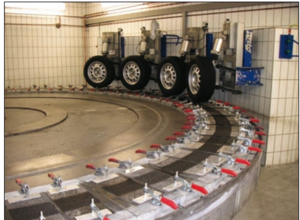
Bild 6: Rundlaufprüfanlage der BAST (BAUM et al.)
