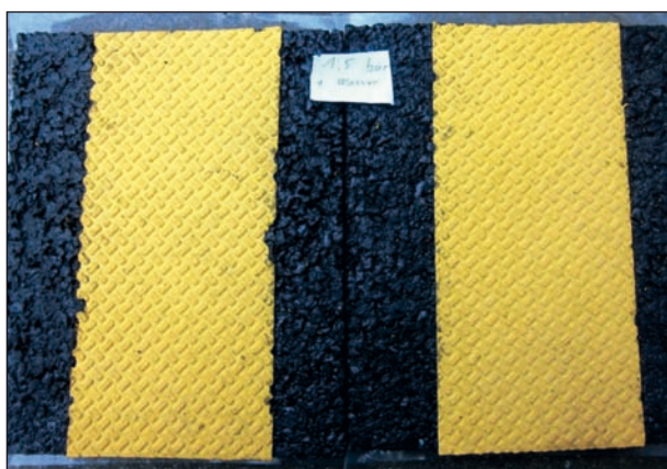
Bild 62: Belastete Probekörper Testreihe 3 (Reifendruck 1,5 bar sowie Wasserzugabe, ohne Zugabe von Poliermittel)
