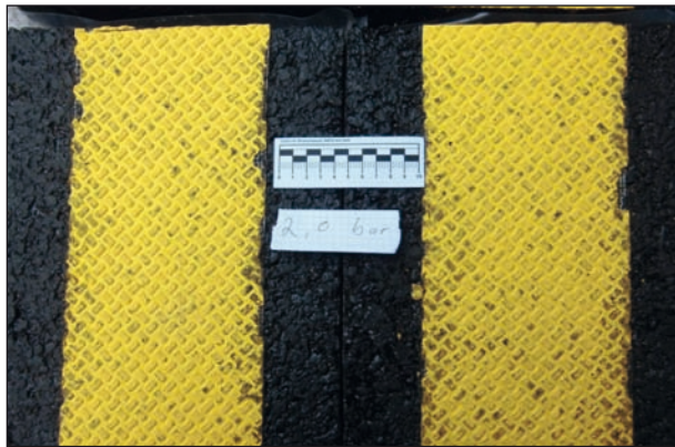
Bild 60: Belastete Probekörper Testreihe 1 (Reifendruck 2,0 bar ohne weitere Zugabe von Wasser und/oder Poliermittel)
