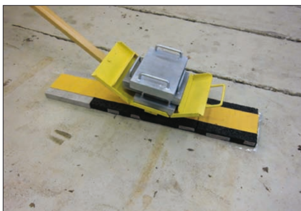
Bild 56: Maschinelles Andrücken mit einem Folienandruckgerät (100 kg Auflast, 3-maliges-Überrollen)
