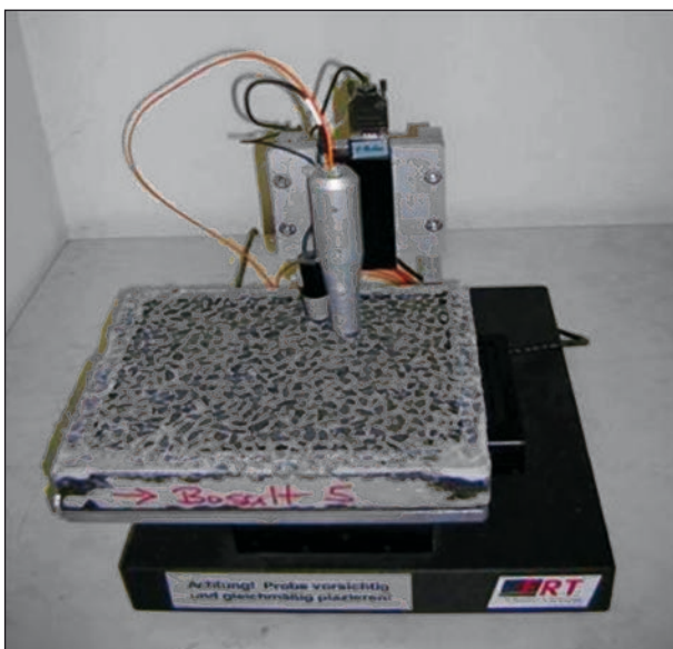
Bild 15: Texturmessgerät „ISAC-FRT“ (STEINAUER et al., 2011)
