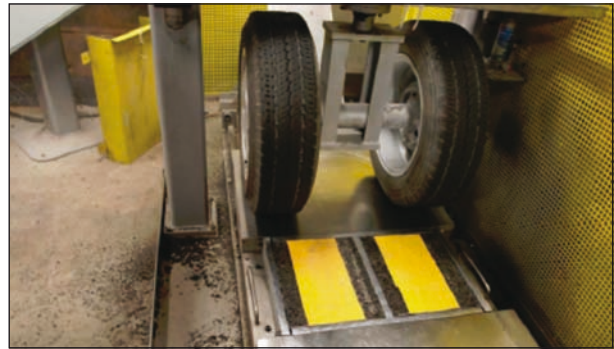
Bild 58: Prüfstand mit applizierter Markierungsfolie
