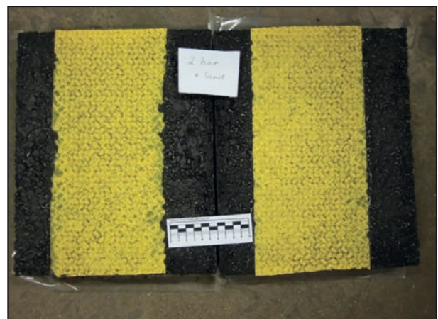
Bild 63: Belastete Probekörper Testreihe 4 (Reifendruck 2,0 bar sowie Sandzugabe, ohne Zugabe von Wasser)
