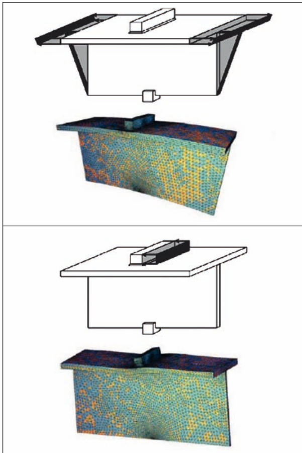
Bild 32: Belastungszustand infolge Biegemoment, rechts: Belastungszustand infolge Schub
