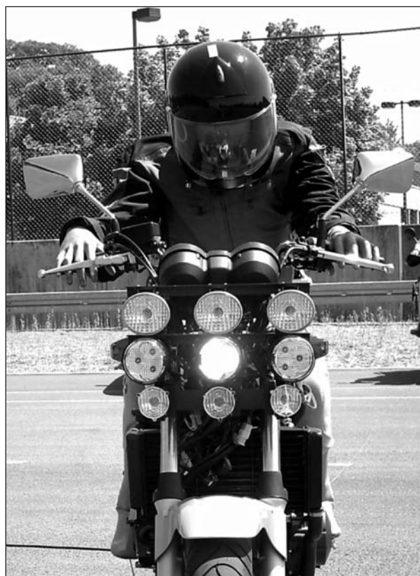
Bild 2.2.8: Signalbild E_{TFL} am Motorrad 1: eine LED-Tagfahrleuchte (650 cd)
