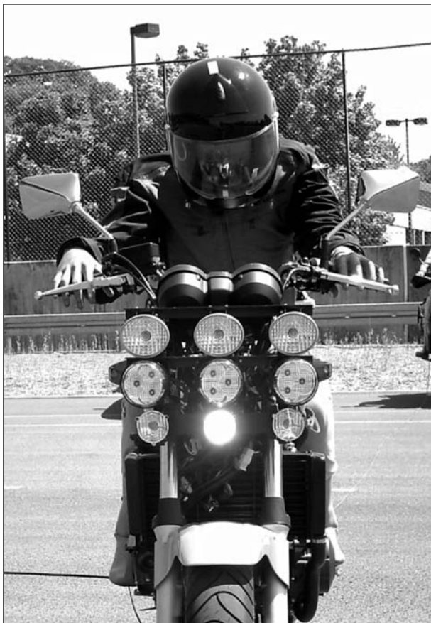
Bild 2.2.9: Signalbild F_{TFL} am Motorrad 1: eine Tagfahrleuchte (1.000 cd)
