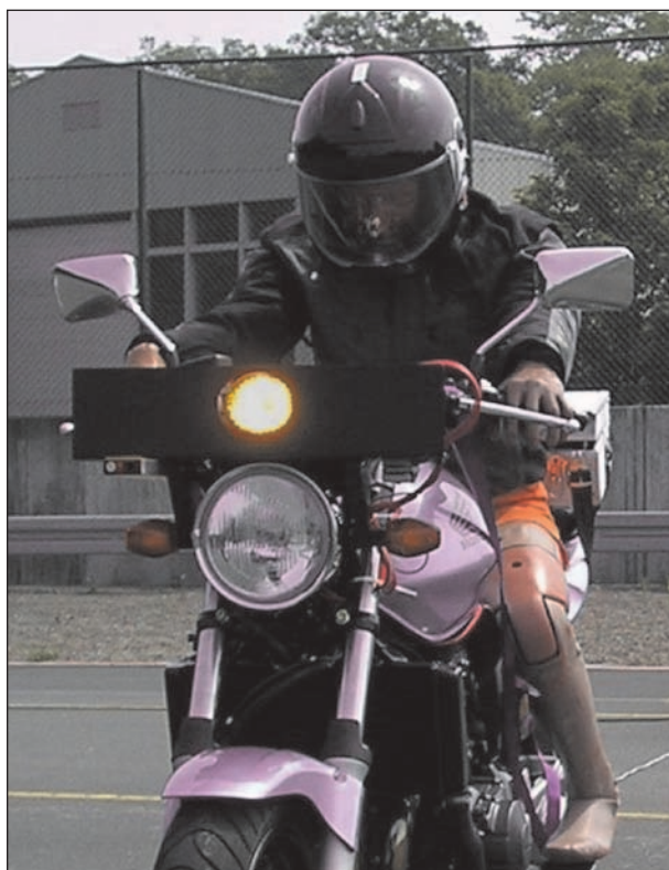
Bild 2.1.7: Signalbild D am Motorrad 1: gelbe Tagfahrleuchte („selective Yellow“)
