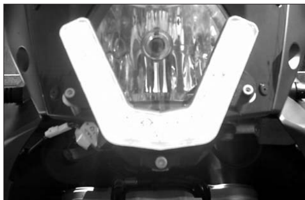
Bild 2.2.10: Signalbild G_{TFL} am Motorrad 2: eine LED-Tagfahrleuchte (800 cd) mit anderer Geometrie
