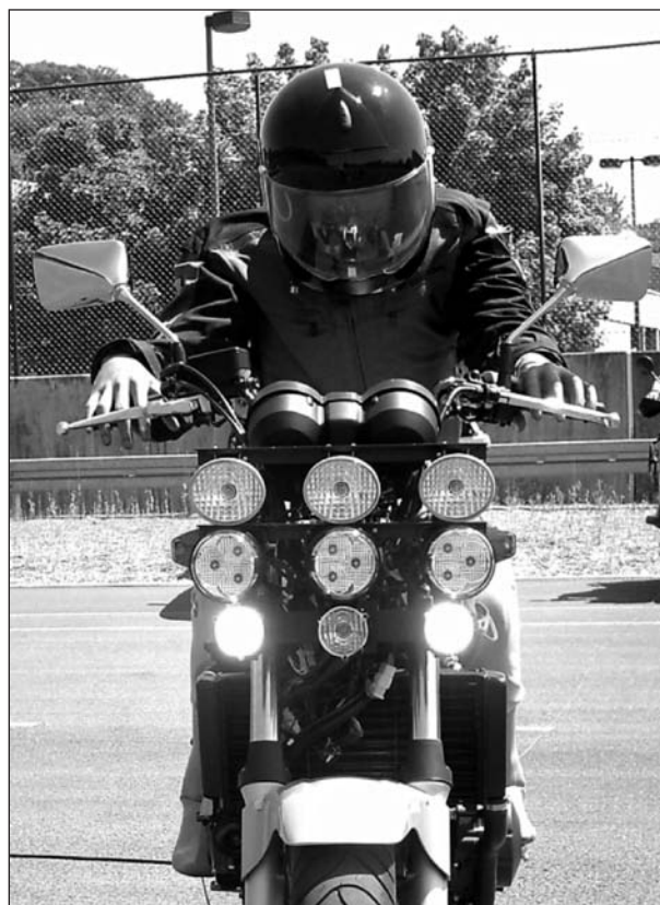
Bild 2.2.7: Signalbild D_{TFL} am Motorrad 1: zwei Tagfahrleuchten (je 1.000 cd)
