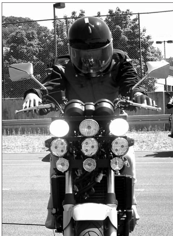
Bild 2.2.5: Signalbild B_{TFL} am Motorrad 1: zwei Tagfahrleuchten (je 500 cd)
