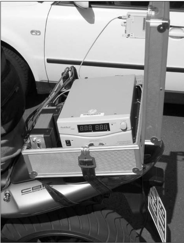
Bild 2.1.2: Stromversorgung und Steuereinheit
