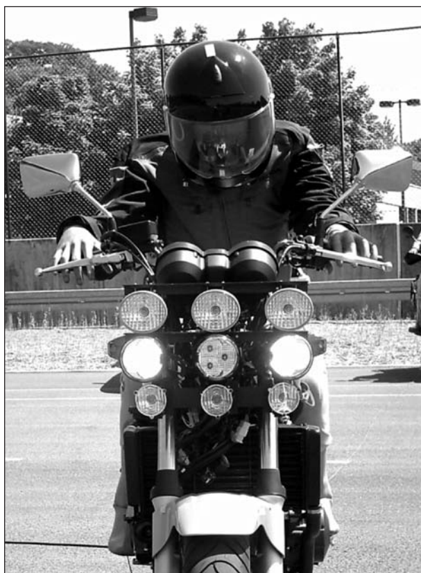
Bild 2.2.6: Signalbild C_{TFL} am Motorrad 1: zwei LED-Tagfahrleuchten (je 650 cd)
