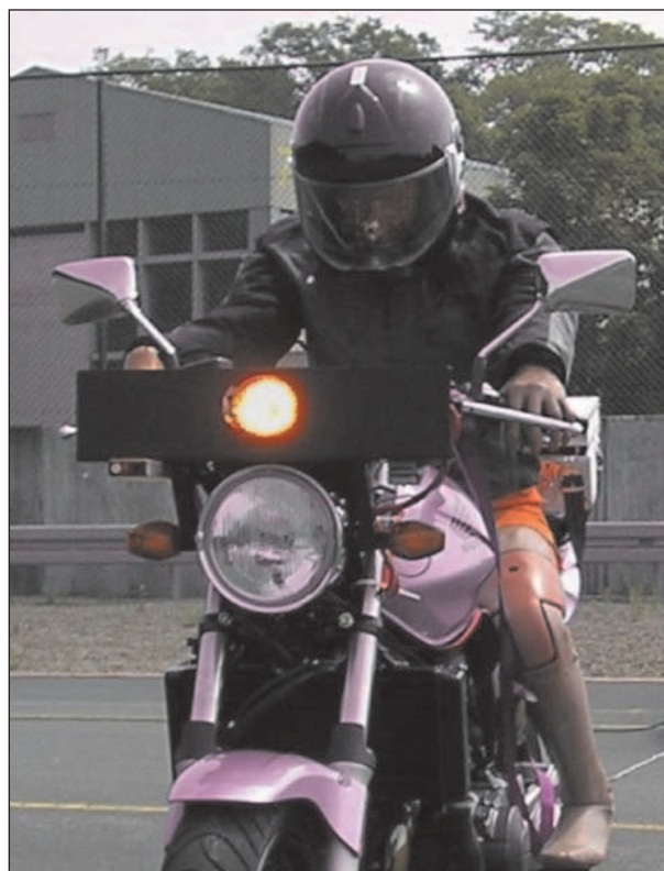
Bild 2.1.8: Signalbild E am Motorrad 1: orangefarbene Tagfahrleuchte („Amber“)
