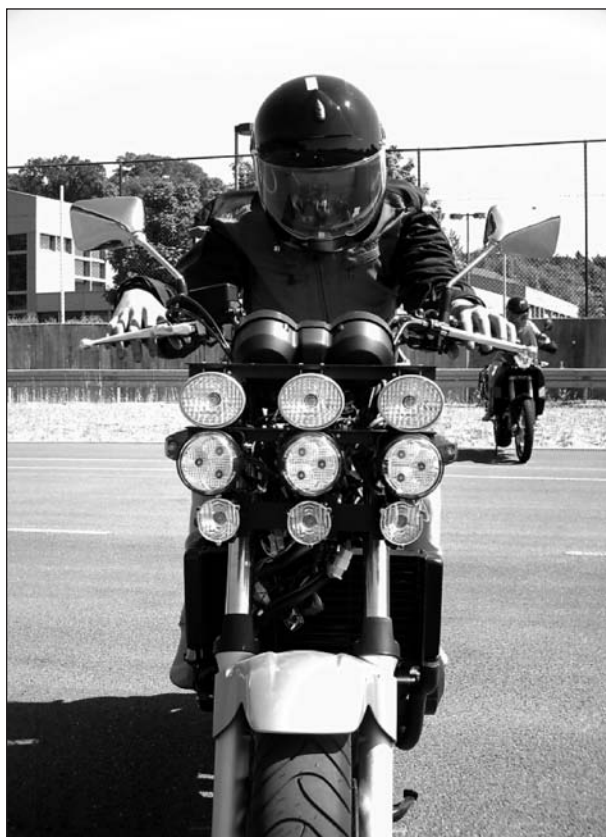
Bild 2.2.1: Anordnung der Tagfahrleuchten am Motorrad 1 für die zweite Versuchsreihe
