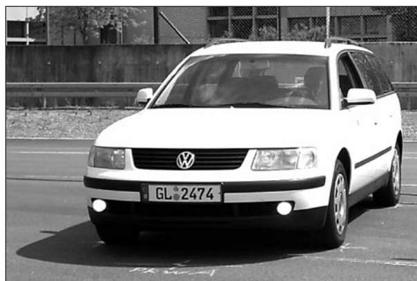
Bild 2.1.9: Pkw mit Nachrüsttagfahrleuchten
