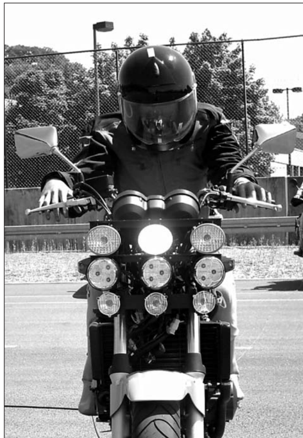
Bild 2.2.4: Signalbild A_{TFL} am Motorrad 1: eine Tagfahrleuchte (500 cd)
