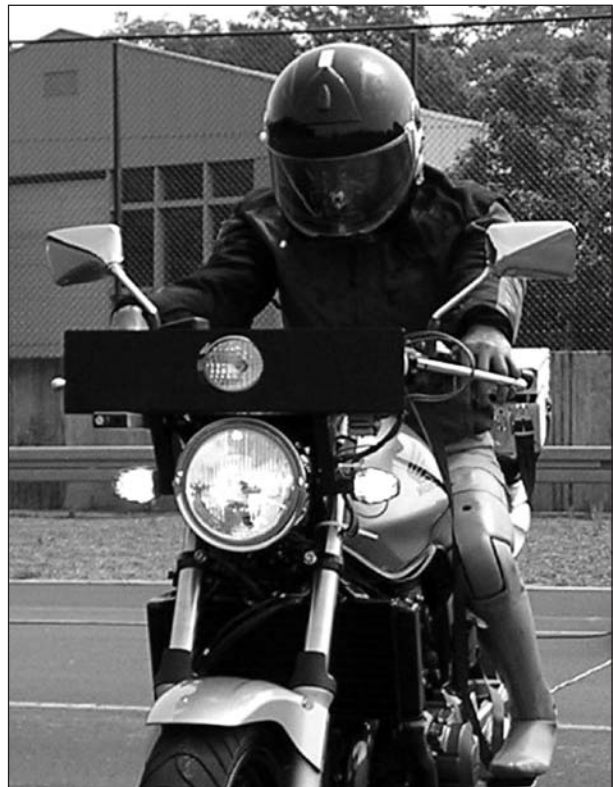
Bild 2.1.5: Signalbild B am Motorrad 1: Abblendlicht mit zusätzlich dauerhaft leuchtenden Fahrtrichtungsanzeigern
