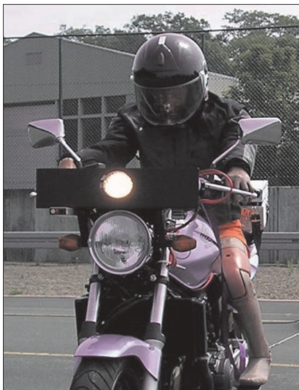
Bild 2.1.6: Signalbild C am Motorrad 1: weiße Tagfahrleuchte
