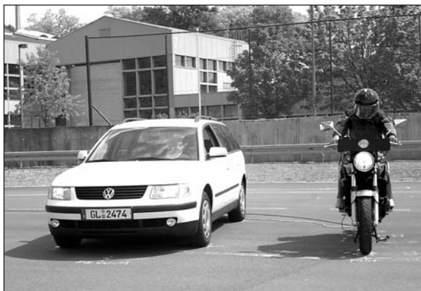
Bild 1.1: Beispielhafter Versuchsaufbau zur statischen Bewertung der Motorradernkennbarkeit (Überholvorgang, Pkw und Motorrad mit eingeschaltetem Abblendlicht)
