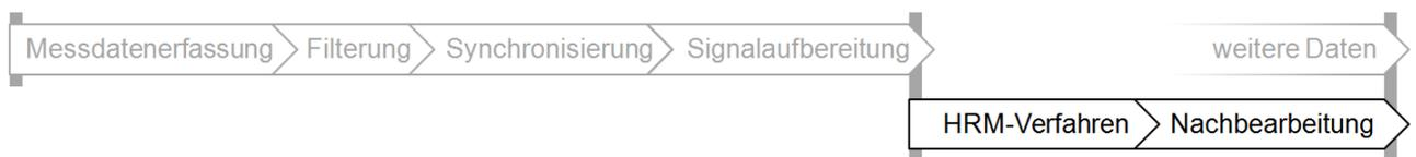
Das HRM- Verfahren ermittelt aus den wegdiskreten Laserdaten ein symmetrisches und ein asymmetrisches Höhenlängsprofil. Typischerweise erfolgt eine Filterung des asymmetrischen Höhenlängsprofils sowie die Zusammenführung beider Profile und abschließende Trendbereinigungen.
