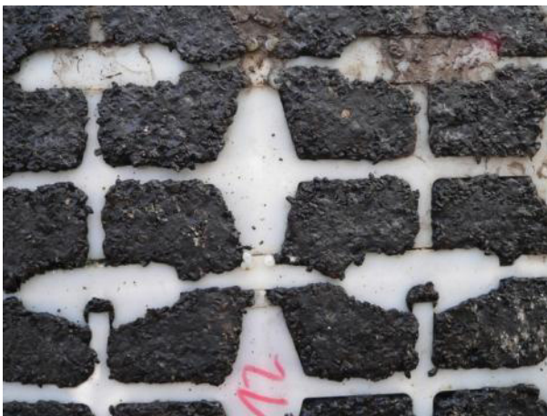
Bild 24: Testfeld A, Unterseite Prüfkörper 500 mm x 500 mm
