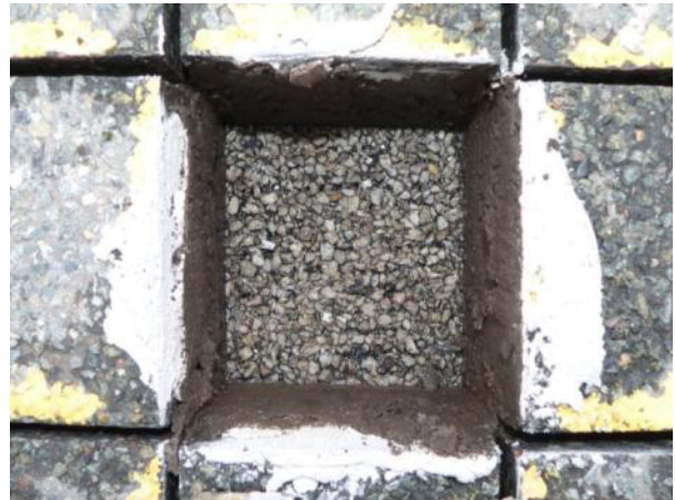
Bild 32: Abstreung Haftschrift (im Überschuss), Schichten-trennung ohne Bindemittelreste auf der Unterlage, Prüfkörper 100 mm x 100 mm
