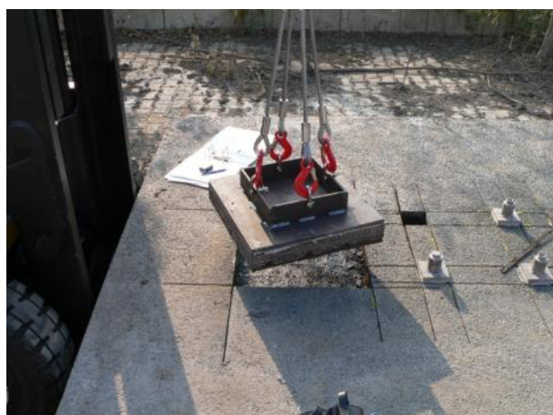
Bild 14: Abgerissener Prüfkörper 500 mm x 500 mm
