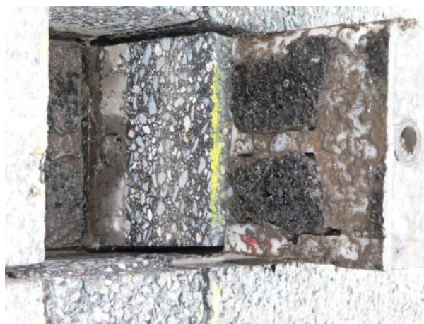
Bild 21: Testfeld A, Unterseite Prüfkörper 100 mm x 100 mm
