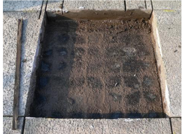
Bild 25: Testfeld A, Unterlage Prüfkörper 500 mm x 500 mm
