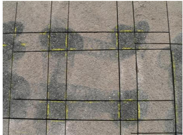
Bild 9: Geschnittene Prüfkörper mit gereinigter Oberfläche
