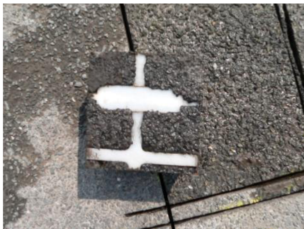
Bild 17: Testfeld A, Unterseite Prüfkörper 100 mm x 100 mm
