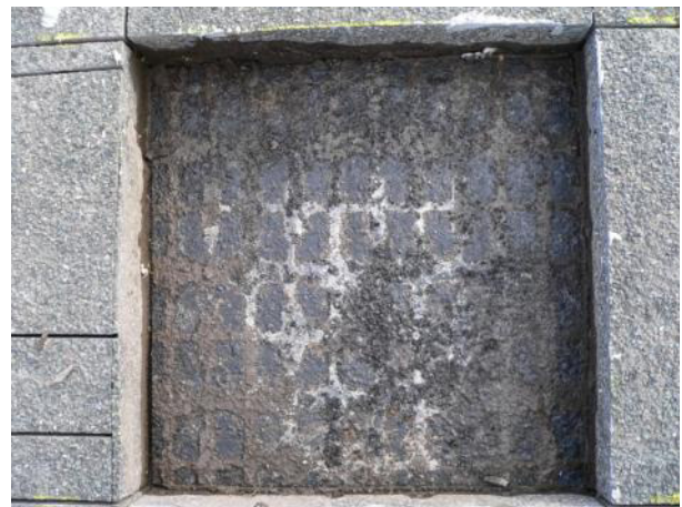
Bild 27: Testfeld A, Unterlage Prüfkörper 500 mm x 500 mm, Schneidschlamm unter den Befestigungsgittern
