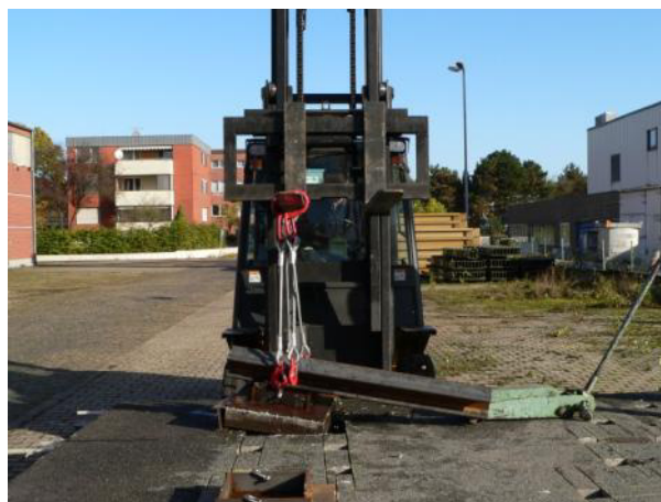
Bild 16: Gelungener Abreißversuch mit hydraulischem Wagenheber und Gabelstapler (Prüfkörper 500 mm x 500 mm)
