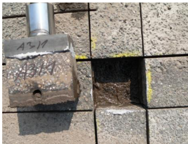
Bild 20: Testfeld A, Unterseite und Unterlage Prüfkörper 100 mm x 100 mm
