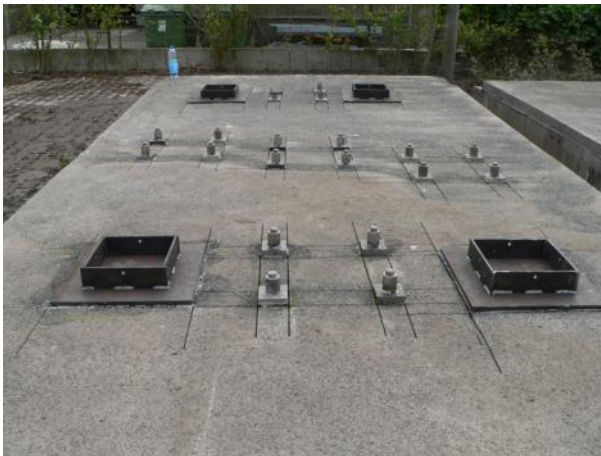
Bild 7: Testfeld A mit geschnittenen Prüfkörpern und aufgeklebten Prüfstempeln
