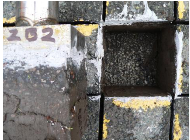
Bild 31: Abstreung Haftschrift (im Überschuss), Schichten-trennung ohne Bindemittelreste auf der Unterlage, Prüfkörper 100 mm x 100 mm
