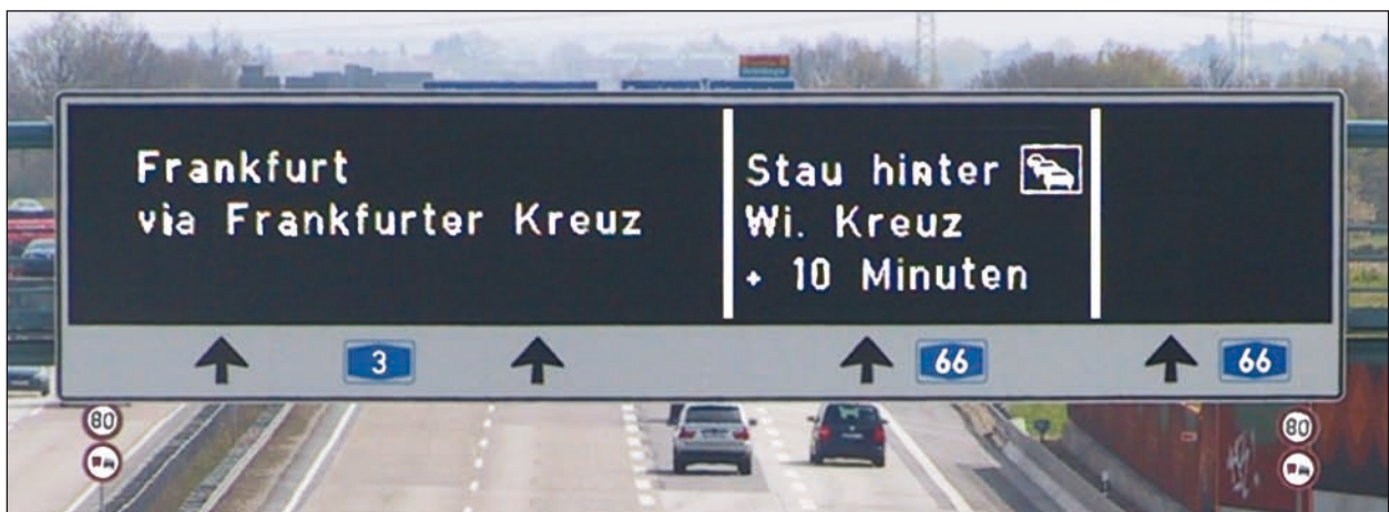
Bild 2-3: dWiSta mit Stauinformation, Verlustzeitanzeige und Umleitungsempfehlung
