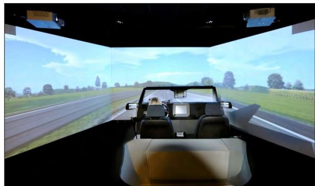
**Bild 10:** Fahrer kabine (Mockup) des Fahr Simulators
