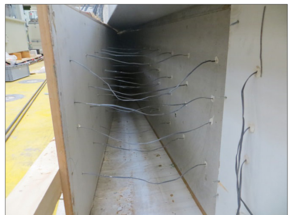
Bild 32: Ausschalen des Versuchsträgers
