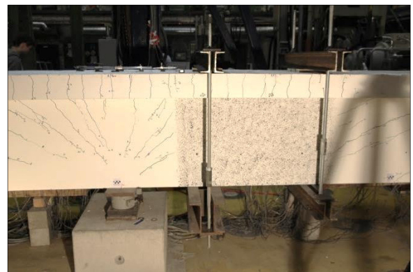
Bild 67: Verstärkung des Trägers mit Traversen und Zugstangen an der Innenstütze
