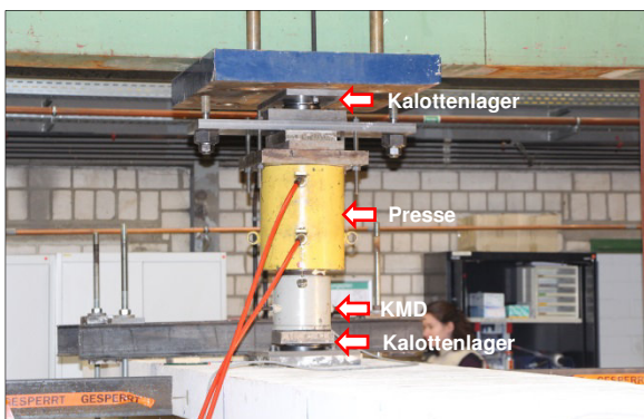
Bild 27: Presse und Kraftmessdose in Belastungsversuch 2; Aufbau in Feld 1
