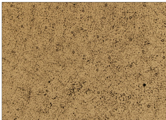
Bild 78: Zufallsmuster für das Messsystem ARAMIS im Messfeld
