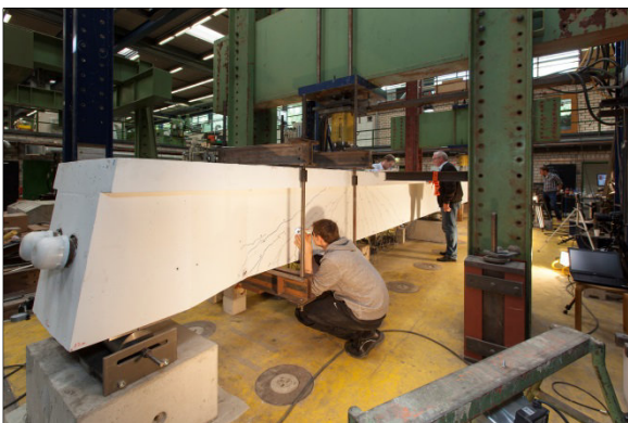
Bild 6: Lagerung des Trägers auf Rollen an den Endauflagern
