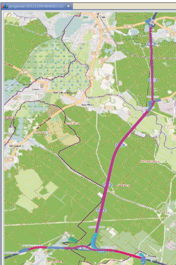
Bild 51: Fahrbahntemperaturen im Verlauf der Einsatztour (Hellblau -2 °C, Mittelblau -1 °C, Graublau 0 °C, Weinrot 1 °C, Rot 2 °C)
