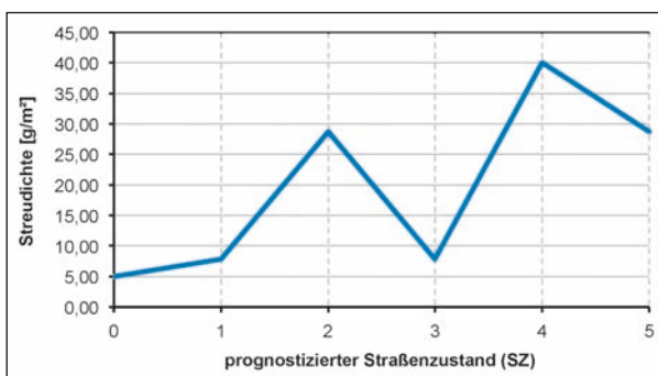
Bild 65: Berechnete Streudichte in Abhängigkeit vom prognostizierten Straßenzustand bei einer Fahrbahntemperatur von -5\text{ }^{\circ}\text{C} (Codierung des Straßenzustandes siehe Tabelle 14)
