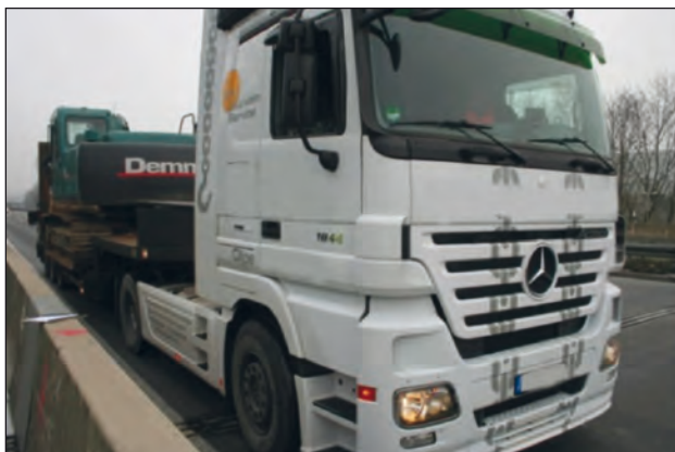
Bild 86: 5-achsiges Belastungsfahrzeug (Fotos)
