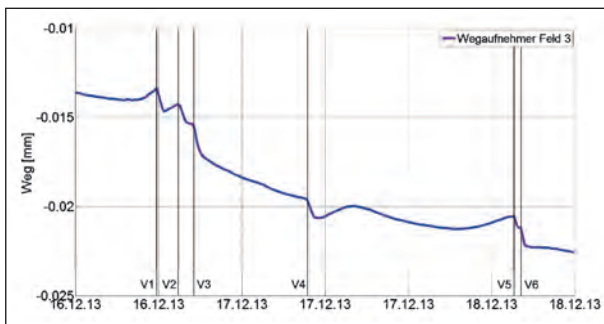
Bild 101: Verlauf der Längenänderung des Betons am unteren Bereich des Steges im Feld 3 (F3-Weg-1-2) während des Vorspannens der sechs externen Spannglieder (V1-V6)
