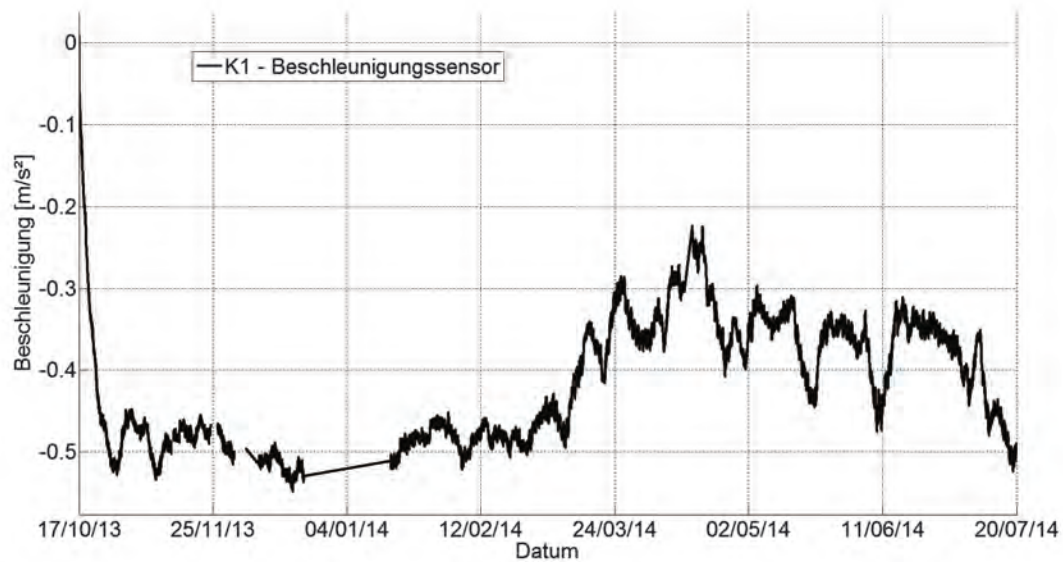
Bild B 6: Zeitlicher Verlauf der verkehrskompensierten vertikalen Beschleunigungen an der Koppelfuge 1 (Mittelwerte aus jedem 15-Minuten-Intervall)
