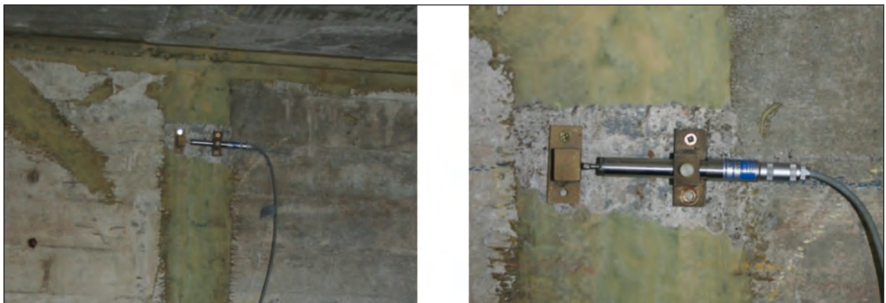
Bild 72: Induktive Wegaufnehmer zur Aufnahme der Rissbreitenänderung
