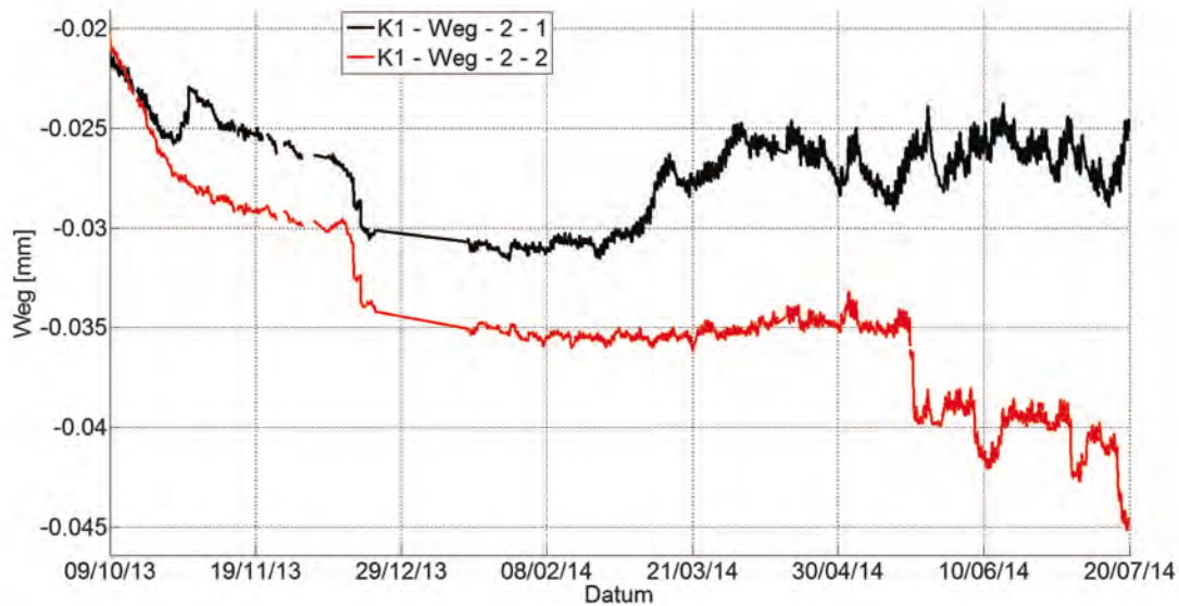
Bild B 3: Zeitlicher Verlauf der verkehrskompensierten Längenänderungen des Betons im Abstand von 2,0 m zur Koppelfuge 1 (Mittelwerte aus jedem 15-Minuten-Intervall)
