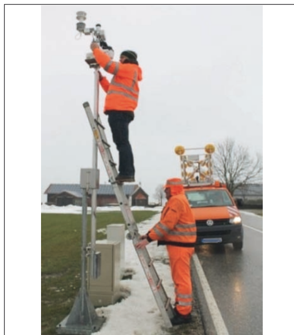
Bild 48: Referenzmessung der Lufttemperatur und der relativen Luftfeuchte auf Sensorhöhe
