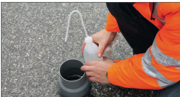
Bild 51: Aufbringen der Sole auf Fahrbahnsensor mit Rohr zu Verhinderung eines zu schnellen Abflusses
