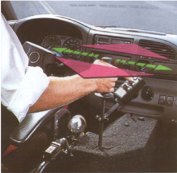
Bild 4.10: Joystick-Lenkung (Bild: Mobilcenter Zawatzky)
