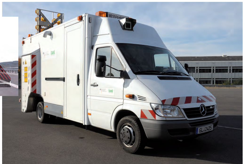
EFA: Erfassungssystem zur Fahrbahnoberflächenanalyse
