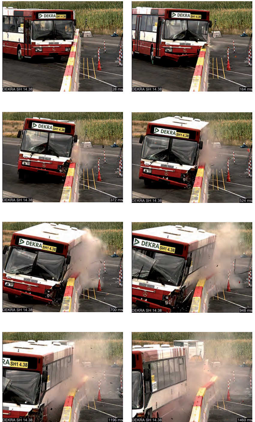
Anprallvorgang mit einem Bus (TB51)
