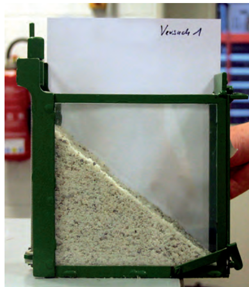
Ergebnisse mit der Auslaufbox (links gute und rechts schlechte Qualität)
