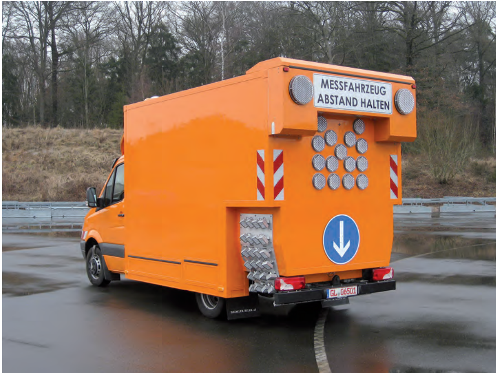
MEFA: Multifunktionales Erfassungssystem zur Fahrbahnoberflächenanalyse
