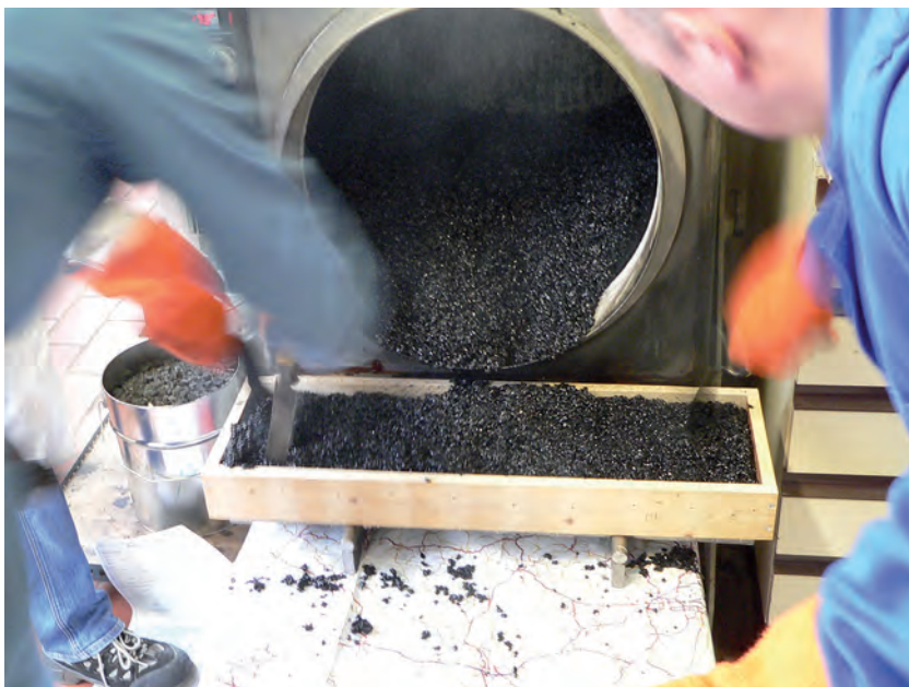
Einbau des Asphaltmischgutes für die Deckschicht der Referenzprobekörper
