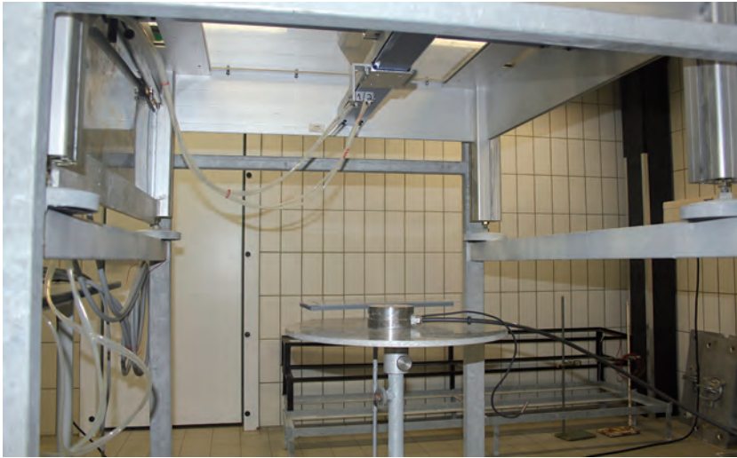
Prüfstand für Bodensonden für Fahrbahnzustand und Gefriertemperatur
