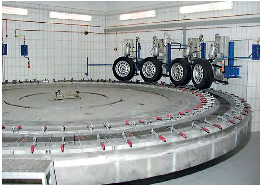
Rundlaufprüfanlage (Ansicht der vier von insgesamt acht Prüfrädern)
