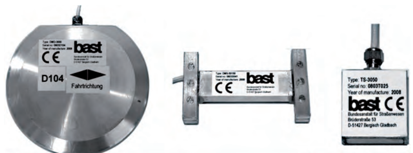
Messfeld mit Druckspannungs-, Dehnungs- und Temperatursensoren
