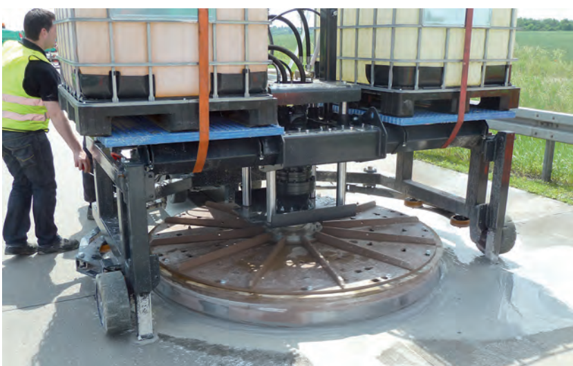
Funktionsprüfung des Spezialkernbohrgerätes (Prototyp) auf der Bundesautobahn A 14
