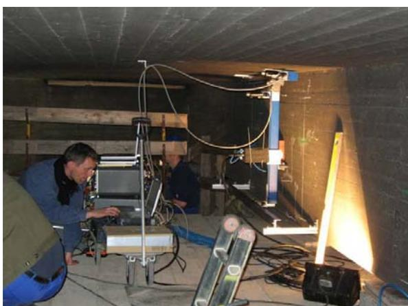
**Bild 11** Klassisches Scannersystem, bestehend aus zwei Linearantrieben am Steg der Brücke
