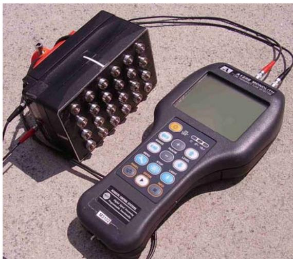
**Bild 13** Ultraschallgerät ACSYS A1220 mit Prüfkopf
