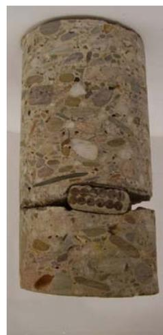
**Bild 55** Von der Unterseite der Fahrbahnplatte entnommener Bohrkern aus der Fahrbahnplatte mit Querspannglied, das eine vollständige Verpressung aufweist.
