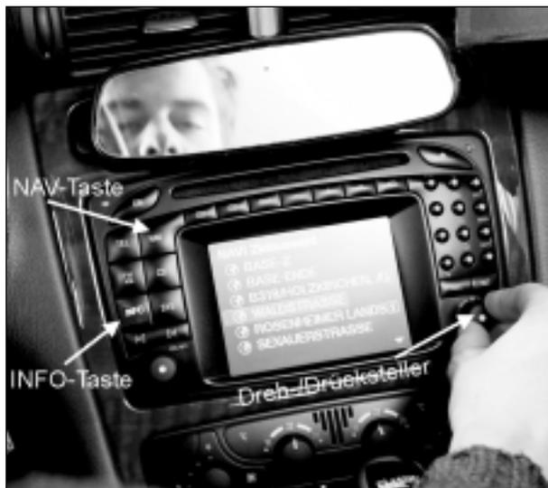
**Bild 35:** Das Comand-System zeigt den Navigationsbildschirm bei der Auswahl der Zwischenziele mit Hilfe des Dreh-/Drückstellers
