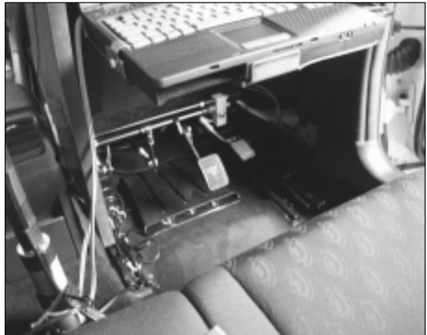
**Bild 46:** Platz des Versuchsleiters hinter dem Beifahrersitz, mit Gas- und Bremspedal zur Simulation des ACC
