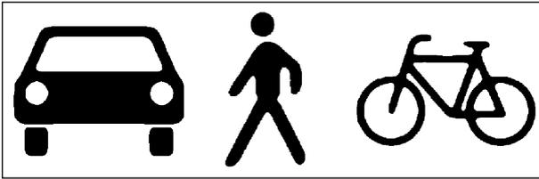
**Bild 42:** Das Fahrzeug-Piktogramm wird beim Überholen eingesetzt, die anderen beiden Symbole beim Rechtsabbiegen, wenn ein Fußgänger oder Fahrradfahrer die Fahrbahn quert
