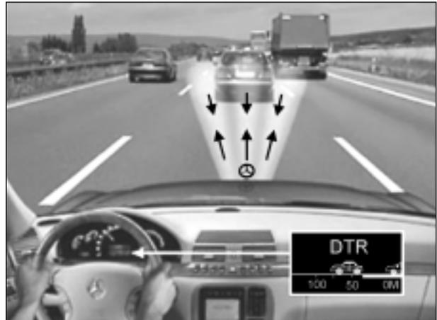
**Bild 45:** Beispiel für die Abstandsbestimmung des ACC, hier mittels Radarsensor, Mercedes-Benz CL-Klasse (aus www, 2001a)
