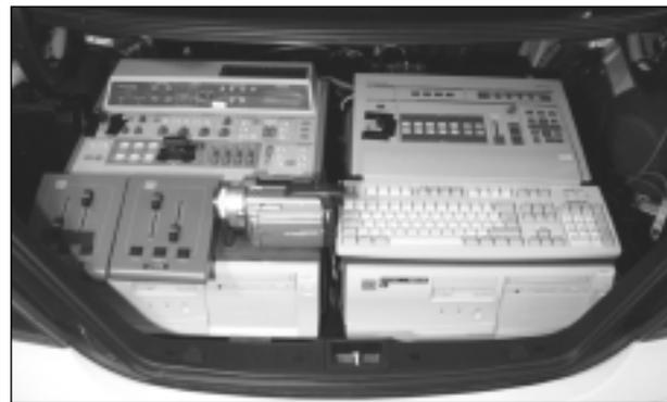
**Bild 44:** Technischer Aufbau im Kofferraum des Versuchsfahrzeugs
