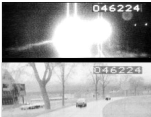
**Bild 7:** Verbesserung der Sicht des Straßenraums durch Infrarot-Technologie (von HELLA)
