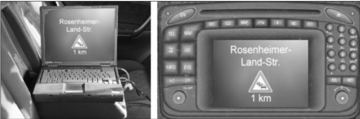
**Bild 37:** Stau-Information, links auf dem Laptop des Versuchsleiters, rechts auf dem Bildschirm des Comand-Systems für den Fahrer
