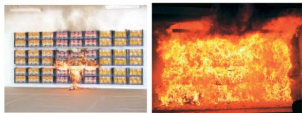
**Bild 8:** Beginn Brandversuch und Vollbrandphase nach 5 Minuten<sup>15</sup>
