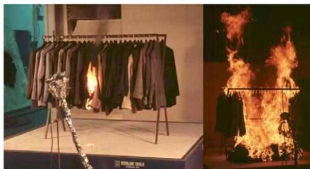
**Bild 13:** Beginn Brandversuch und Vollbrandphase
