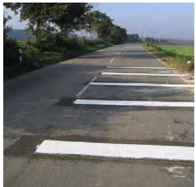
**Bild 76:** Messtechnische Voruntersuchungen zur Abfolge mehrere Rüttelstreifen – Messtrecke mit fünf Versuchskörpern
