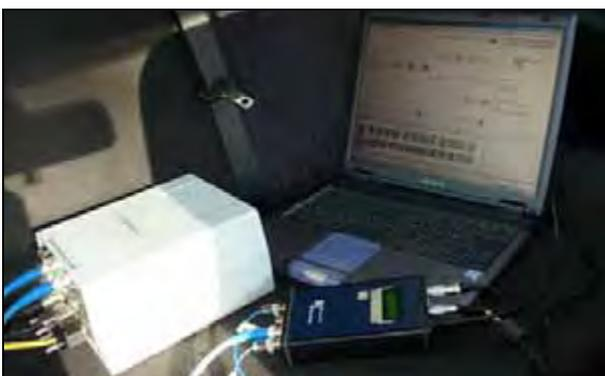
**Bild 71:** Realtime Data-Logger (Squadriga) (vorne) verbunden mit Synchronisationseinheit (links) und Notebook
