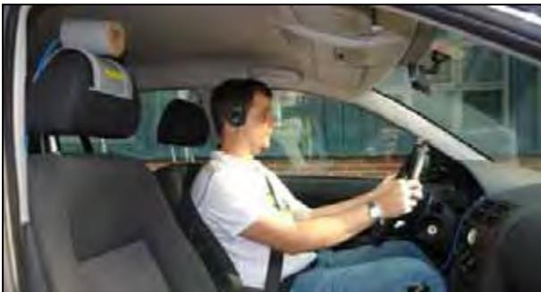
**Bild 69:** Messmikrofon und Fahrer mit binauralem Headset
