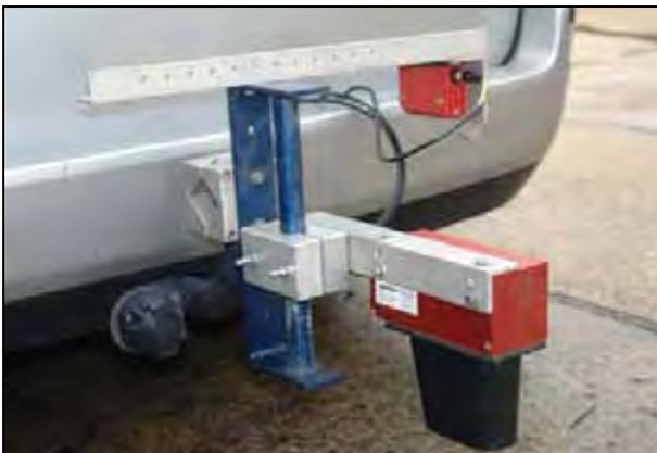
**Bild 70:** Retro-Reflex-Sensor (oben) und Geschwindigkeitssensor (unten) in Messposition am Pkw
