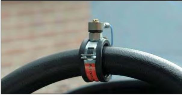
**Bild 68:** Beschleunigungssensoren am Lenkrad des Pkw
