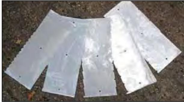
Bild 72: Schablonen aus Stahlblech
