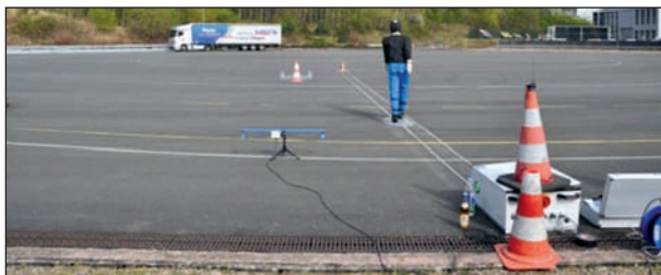
Bild 28: Dummy-Bewegungsanlage von 4active-Systems, aufgebaut zum Test von Fußgänger-Notbremssystemen. Zu erkennen ist in Bildmitte der Fußgängerdummy, der über Magnete mit einem Brett gekoppelt ist. Dieses Brett wird durch den ringförmigen Riemen bewegt. Der Antrieb des Riemens erfolgt durch einen Elektromotor im großen Kasten im Vordergrund, ein Gegenlager mit Riemenscheibe für die Führung des Riemens befindet sich im Hintergrund
