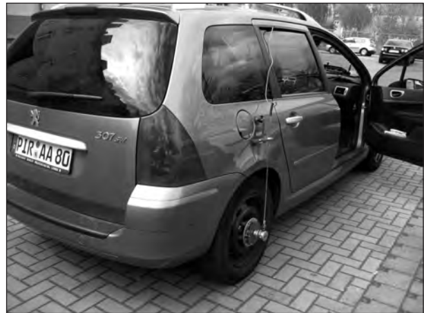
Bild 4.5: Messfahrzeug der TU Dresden mit angebautem Peiseler-Messrad
