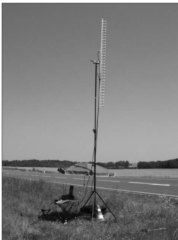
Bild 5.4: Messaufbau zur Bestimmung der vertikalen Richtcharakteristik von Fahrzeugen
