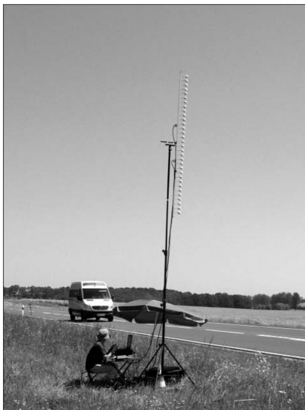
Bild 5.12: Bestimmung der vertikalen Richtcharakteristik des Kleintransporters
