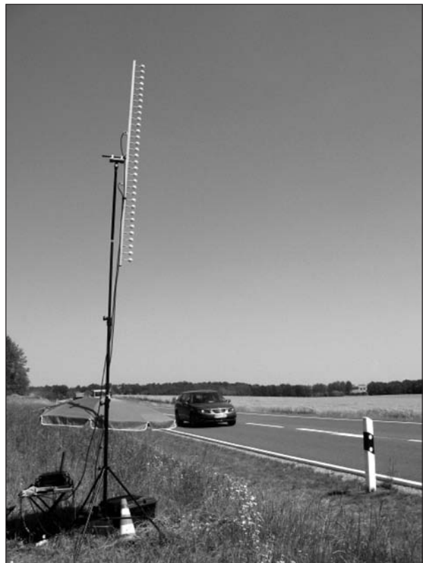
Bild 5.12: Bestimmung der vertikalen Richtcharakteristik des Pkw
