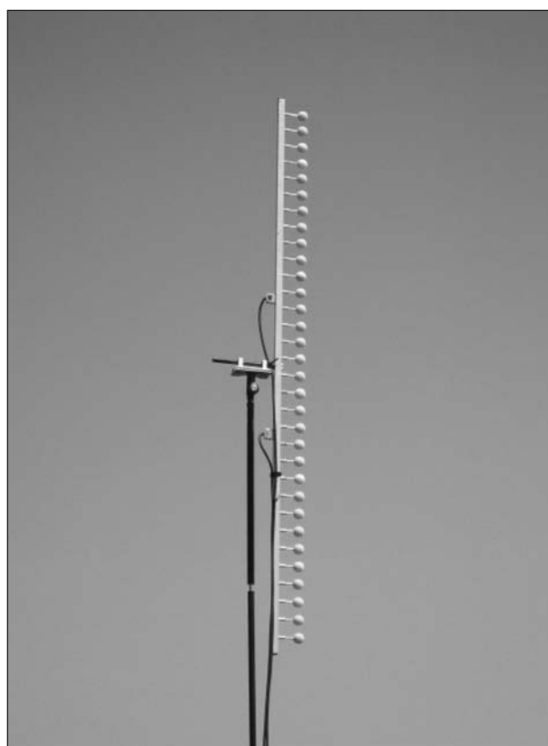
Bild 5.5: Detailansicht 32-kanaliges Mikrofonarray
