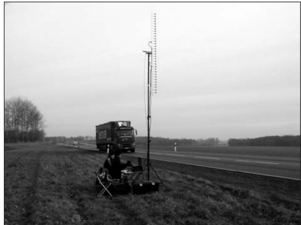
Bild 5.11: Bestimmung der vertikalen Richtcharakteristik des Lkw
