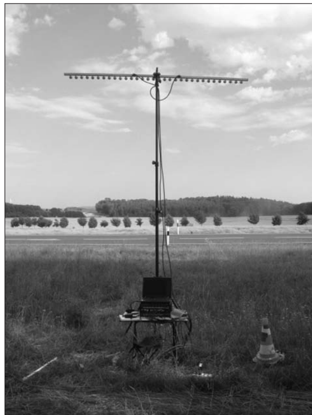
Bild 5.3: Messaufbau zur Bestimmung der horizontalen Richtcharakteristik von Fahrzeugen
