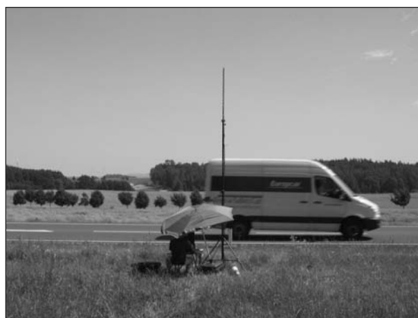
Bild 5.6: Kontrollierte Vorbeifahrt des Testfahrzeugs
