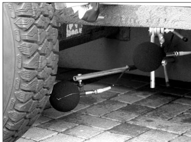
Bild 21: Reifen D mit Messmikrofonen (MP 4 und MP 1)
