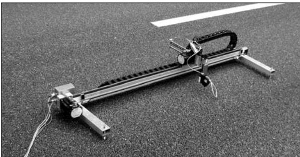
Bild 16: Texturmessgerät
