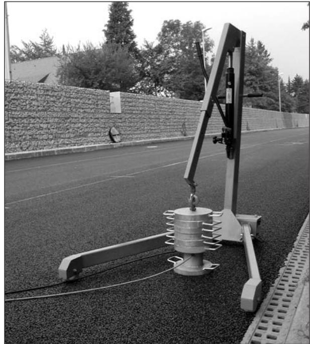
Bild 6: Messgerät für Strömungswiderstand: praktischer Aufbau des Messsystems mit Hebeeinrichtung
