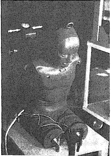
Bild 8: Versuchsaufbau zur Messung der Lenden- wirbelsäulenbiegung (Kalibrierung)
