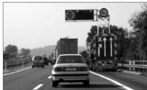
**Bild 19:** LED-Vorwarnsystem mit Überkopfsignalisierung (Österreich) [SCHWARZ (2006)]
