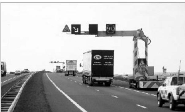
**Bild 18:** Einsatz des Mobile Lane Signalling System (MRS) in den Niederlanden [Bildquelle: HYTRANS (2006)]
