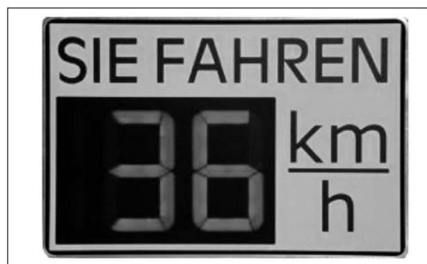
**Bild 31:** Geschwindigkeitsanzeige [Bildquelle: SIERZEGA (2006)]
