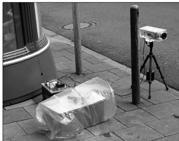
Bild 6.2: Videokamera und Zubehör zur Messung der Reisezeiten
