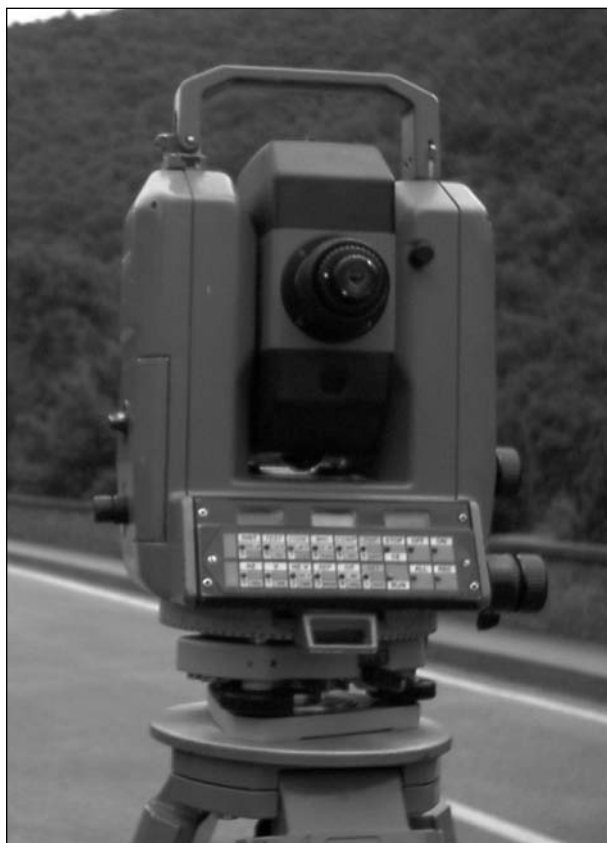
Bild 4-1: Verwendetes elektronisches Tachymeter
