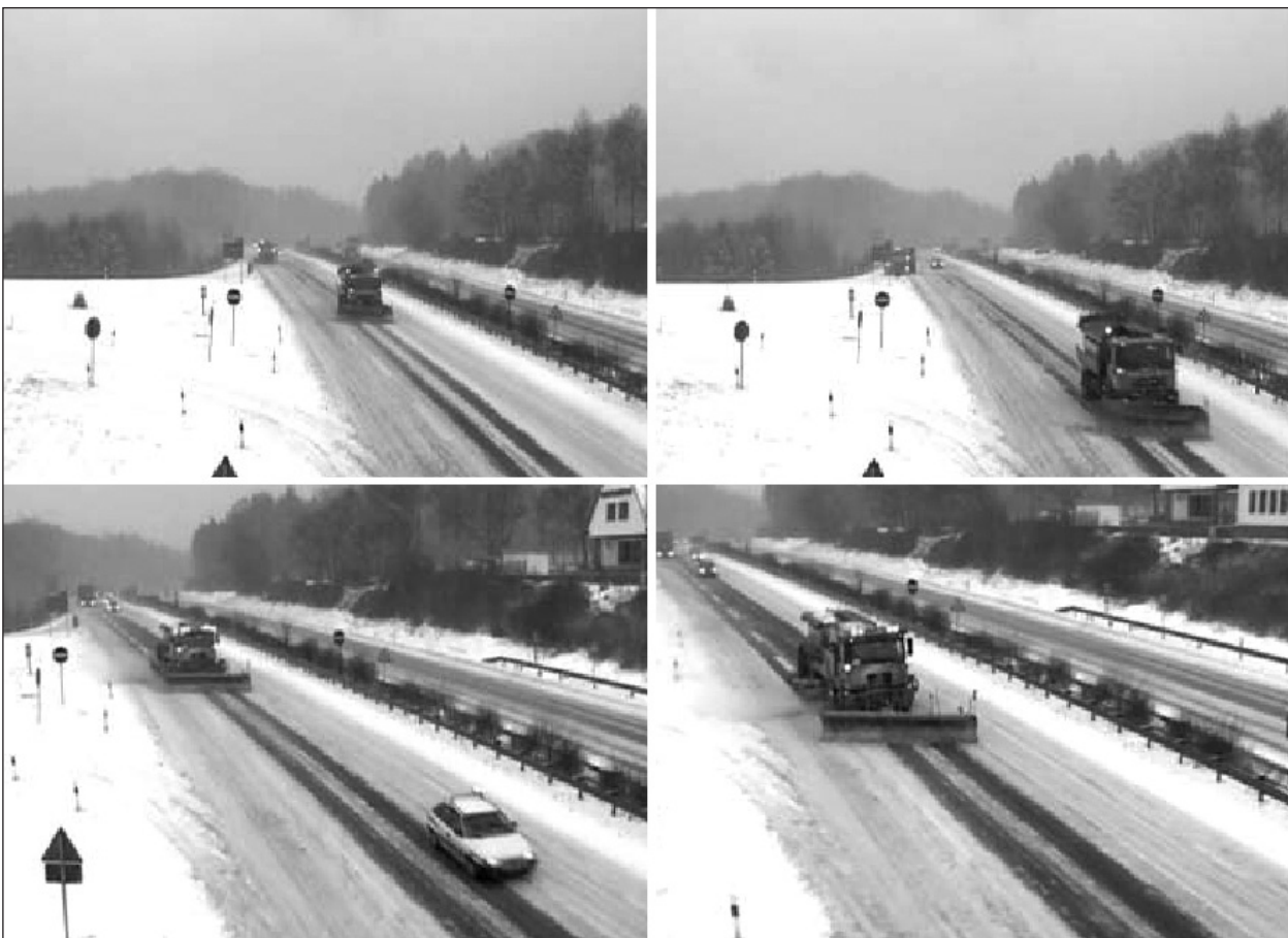
Bild 9: Vergleich des Räumbildes zwischen einem Standard-Winterdienstfahrzeug (oben) und dem Hochleistungs-Kehrblas-Gerät (unten) am 13.01.2003 an der Raststätte Rimberg [Videobilder]
