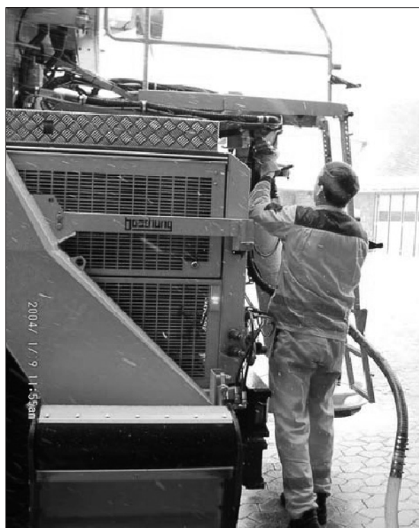
Bild 25: Betanken mit Salzlösung im Gehöft der AM Alsfeld
