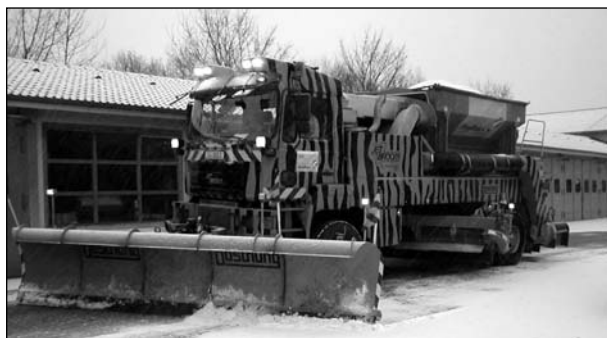
Bild 7: Hochleistungs-Kkehrblas-Gerät als Straßenwinterdienstfahrzeug der AM Freudenberg
