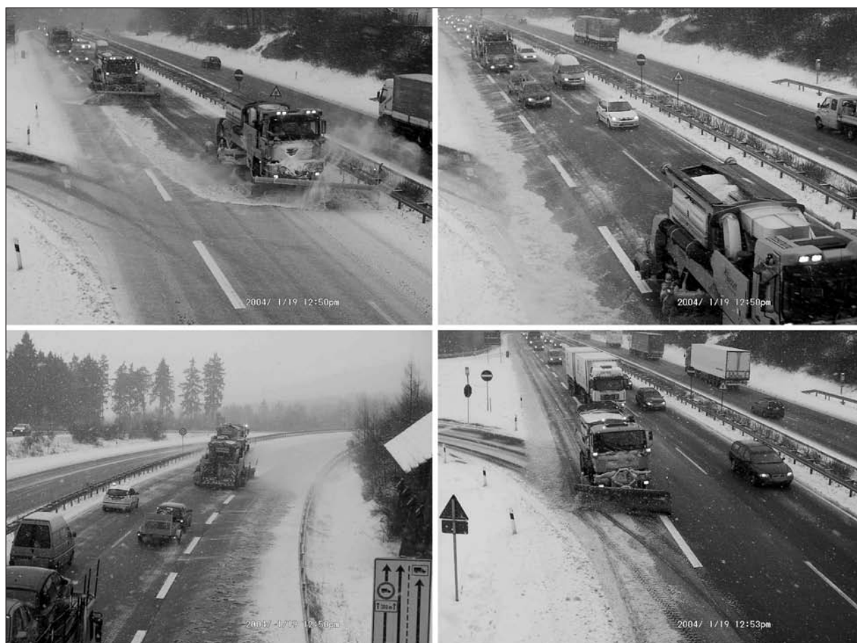
Bild 11: Vergleich der Räumergebnisse bei Staffleräumung durch Hochleistungs-Kehrblas-Gerät und Standard-Winterdienstfahrzeug (unten rechts) am 19.01.2004 an der Raststätte Rimberg
