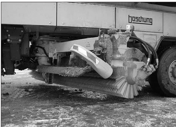
Bild 17: Kehrwalze mit Bürstenbesatz aus Polypropylen (links) und Stahl (rechts)
