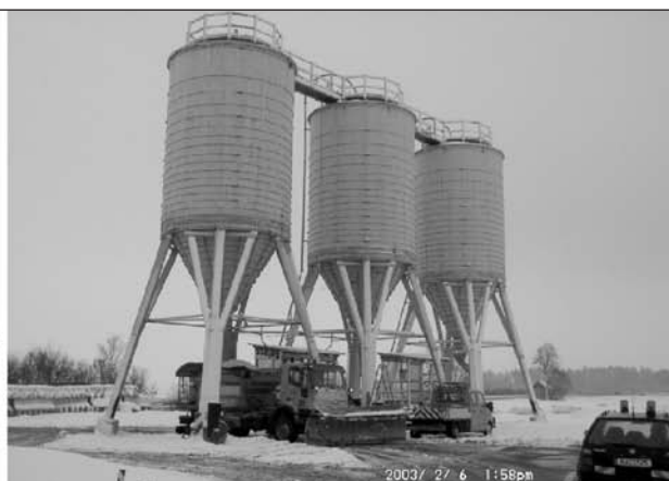
Bild 41: Beladung mit 250-t-Streustoffsilos am Stützpunkt Merklingen der AM Ulm-Dornstadt
