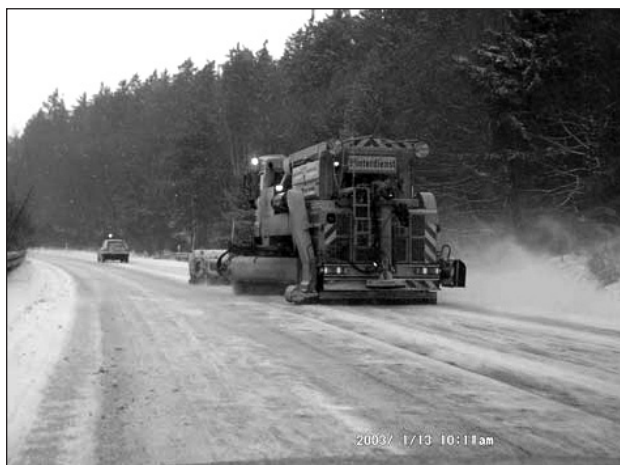
Bild 15: Unterschiedliche Wirkung von Pflug und Kehrwalze am 13.01.2003 [Videobild]
