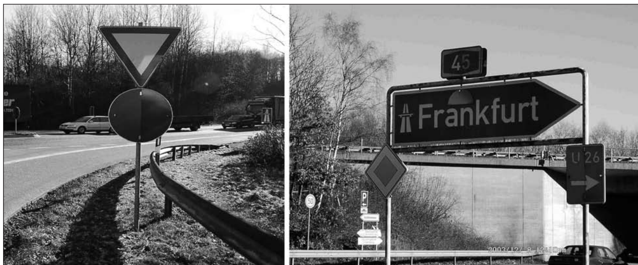
Bild 51: Klappschild zum Sperren der Anschlussstelle, hier AS Freudenberg der A 45
