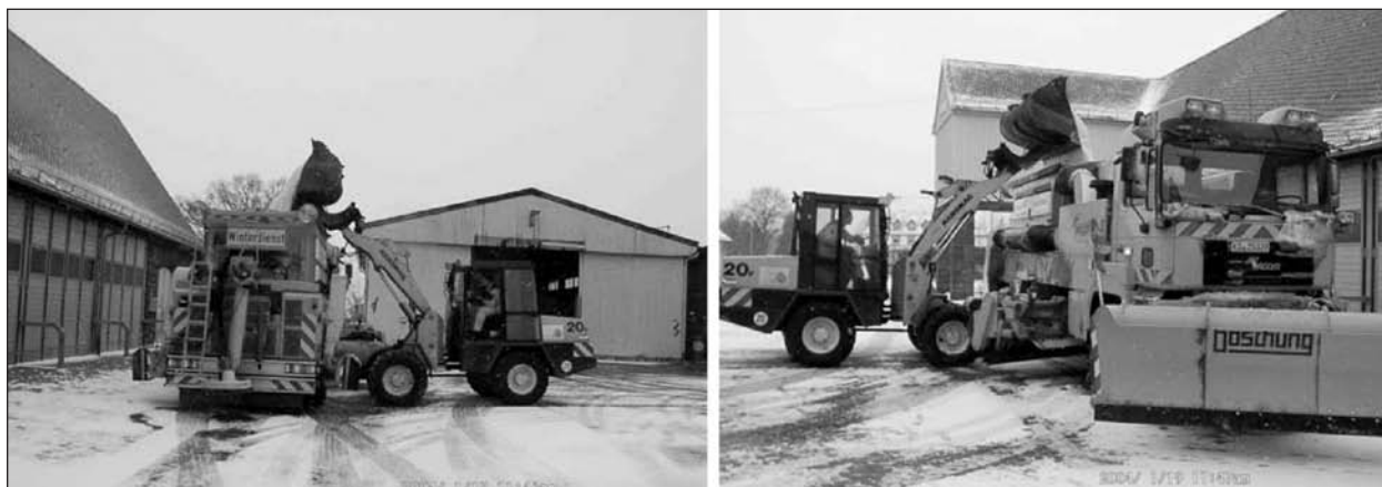
Bild 23: Beladen von Trockensalz mit Radlader im Gehöft der AM Alsfeld
