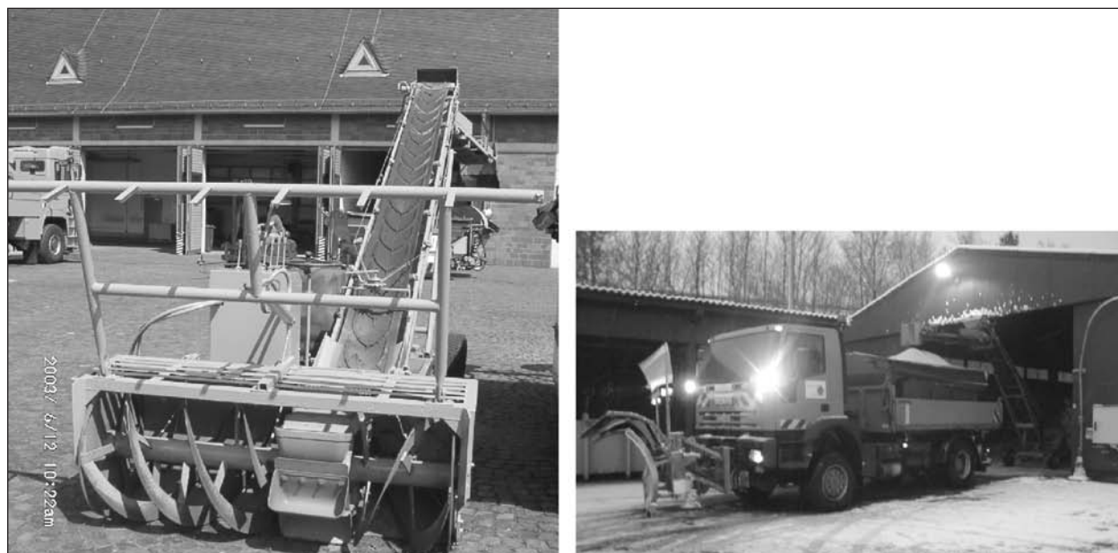
Bild 38: Streustoffförderband und Beladung mit Streustoffförderband in der AM Kirchheim
