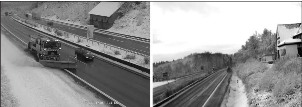
Bild 13: Geräumter Standstreifen durch Hochleistungs-Kehrbles-Gerät am 30.01.2003
