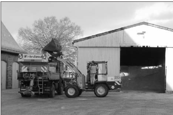
Bild 39: Beladung eines Winterdienstfahrzeugs per Radlader mit Hochkippschaufel (AM Alsfeld)
