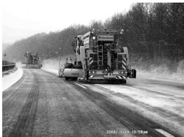
Bild 16: Schlechte Räumqualität durch Fehleinstellungen der Kehrwalze oder Dejustierungen nach längeren Einsätzen, hier beispielhaft am 13.01.2003 (oben) und am 19.01.2004 (unten)
