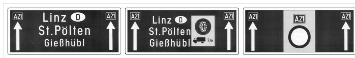
Bild 55: Schaltungen der Wechselwegweisungsanlage auf der A 21 von Normalzustand über Kettenanlegepflicht bis hin zu temporärer Fahrbahnsperrung [Bildquelle: Amt der Niederösterreichischen Landesregierung, Österreich]
