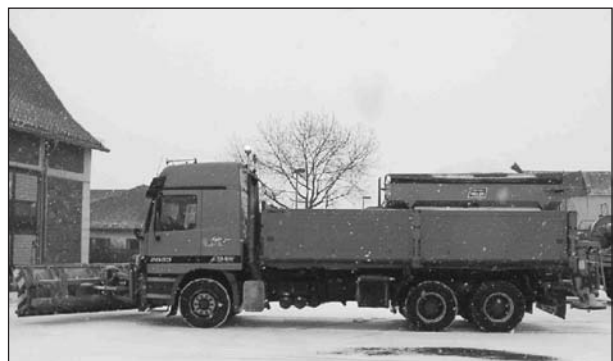
Bild 37: Als Winterdienstfahrzeug ausgestatteter Lkw eines Fremdunternehmers
