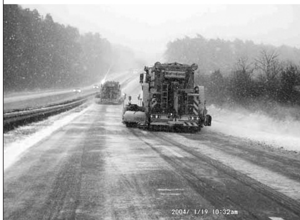
Bild 16: Schlechte Räumqualität durch Fehleinstellungen der Kehrwalze oder Dejustierungen nach längeren Einsätzen, hier beispielhaft am 13.01.2003 (oben) und am 19.01.2004 (unten)
