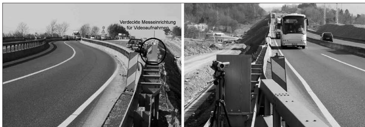
Bild 28: Messeinrichtung für verdeckte Videoaufnahmen
